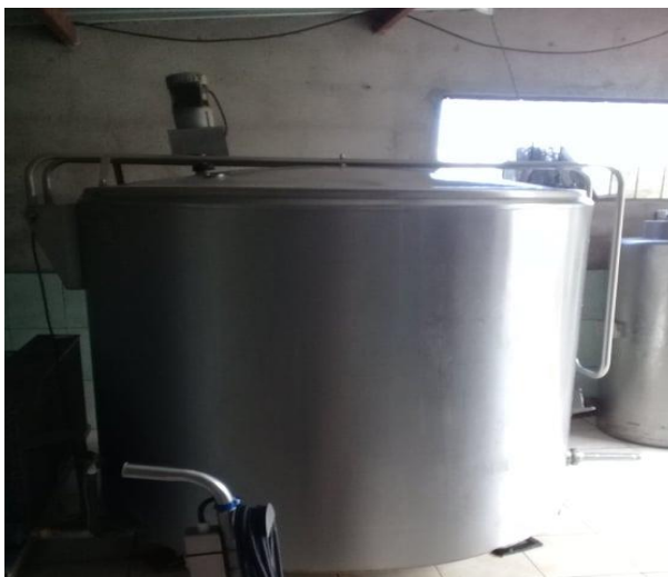
Figura 29 Tanque de refrigeración de leche
