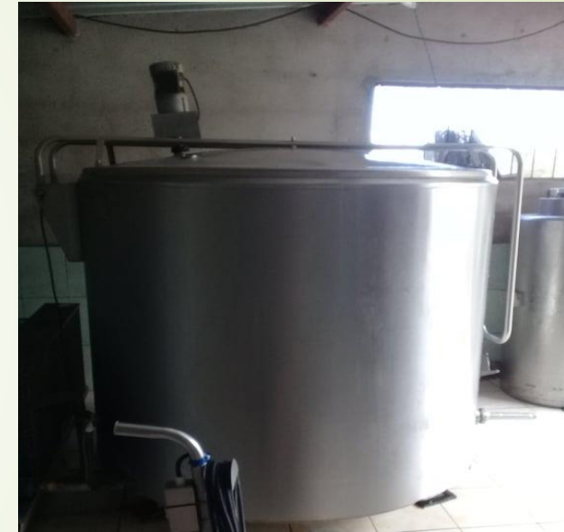
Tanque de refrigeración de leche
