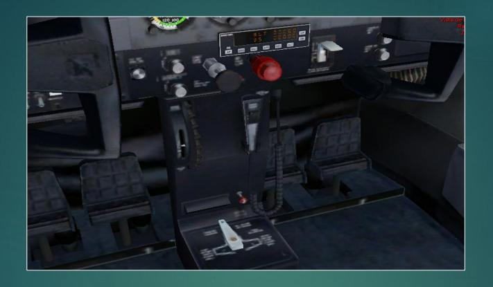
▶ Los Cessnas disponen de mandos de varilla en vez de palancas, pero el manejo es sencillo, empujando el mando de gases se aplica más potencia y tirando del mismo menos potencia; empujando el mando de paso de la hélice se seleccionan más r.p.m. y tirando se seleccionan menos r.p.m.
