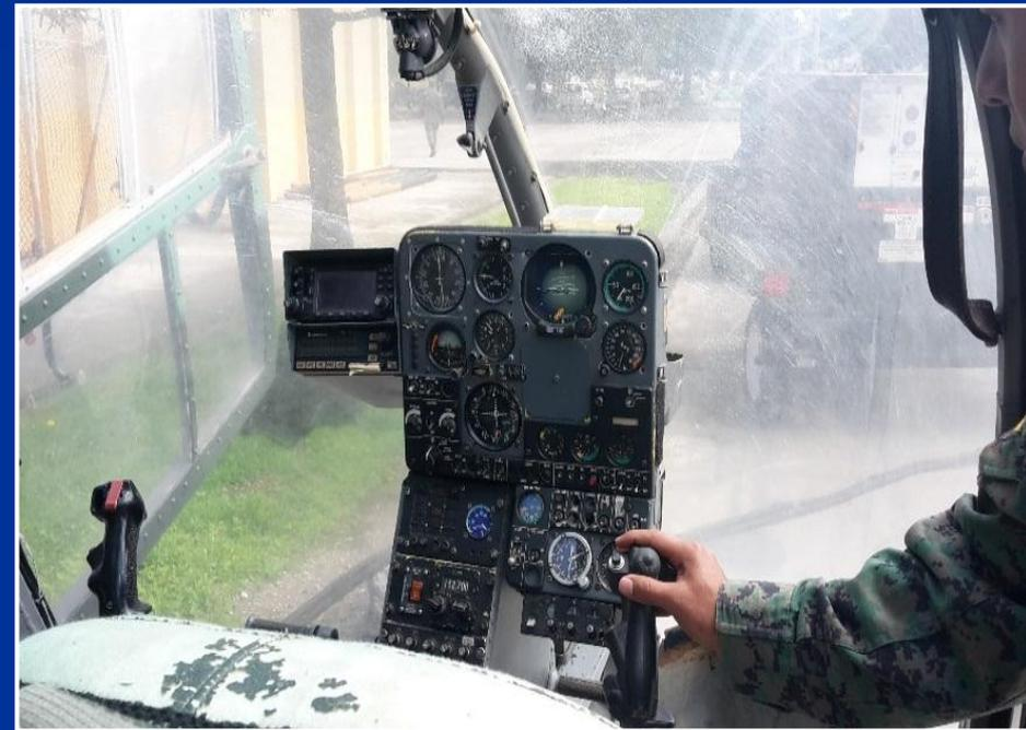
El sistema de arranque se encuentra inoperable La aeronave fue canibalizada con el propósito de mantener operables al resto de aeronaves.
