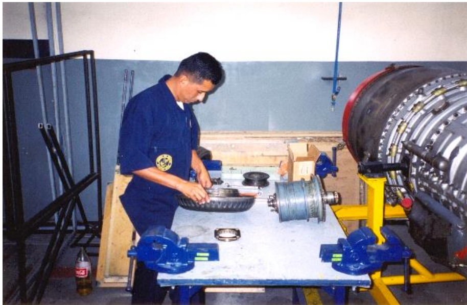
Figura 3.7. Desarmado del conducto pequeño. Conjunto del compresor
