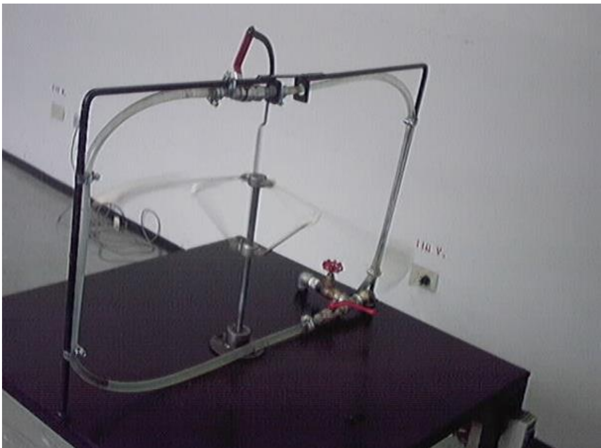
Fotografía A. 3. Governor de Sobrevelocidad Didáctico en funcionamiento
