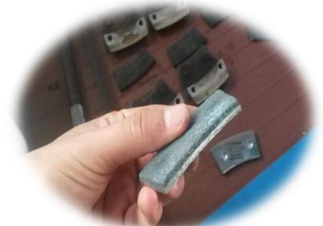
Remover los lining de la placa de presión
