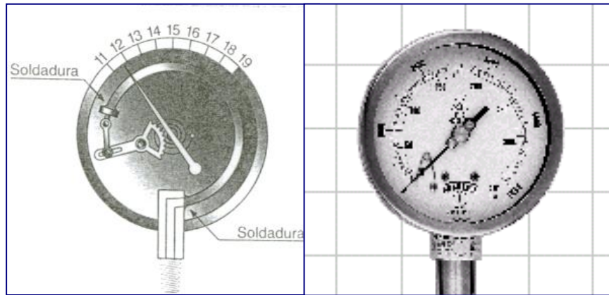
Figura. 1.7. Manómetro de Bourdon.
