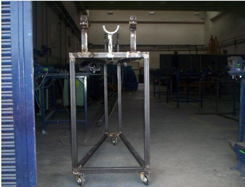
**Figura 3.9 Construcción del soporte móvil para el tren de nariz del avión**
