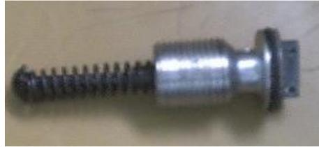
**Fig. 1.11.- Válvula reguladora de presión**
