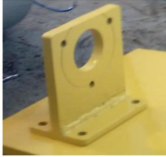
**Fig. 3.4 Soporte para Bomba**
