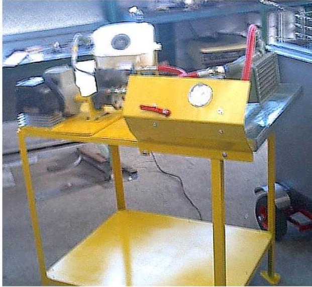
**Fig. 3.9.- Banco para el Flushing de Radiadores de Aceite**
