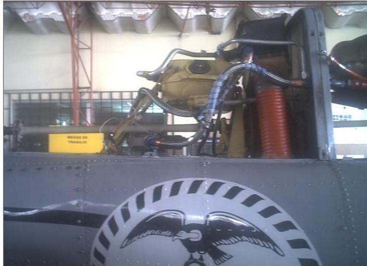
**Fig. 1.1.- Sistema de Aceite del Helicóptero Bell 206**
