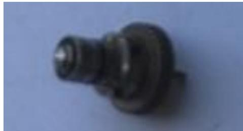
**Fig. 1.12.- Detector de limallas**
