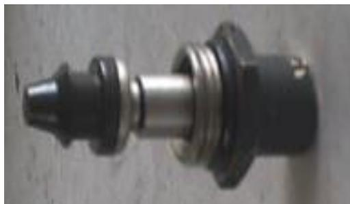
**Fig. 1.8.- Válvula de desviación**
