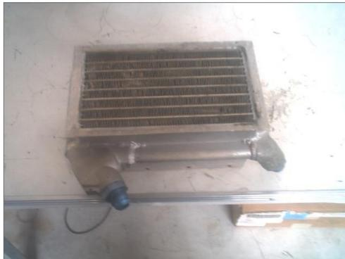
**Fig. 1.6.- El Enfriador de Aceite de Motor**
