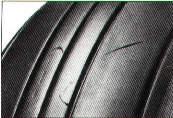
Fig.1.14 Cortes en la banda de rodamiento
