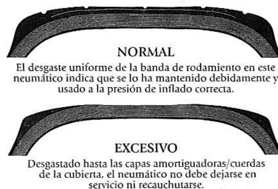
Fig. 1.13 Desgaste de la banda de rodamiento
