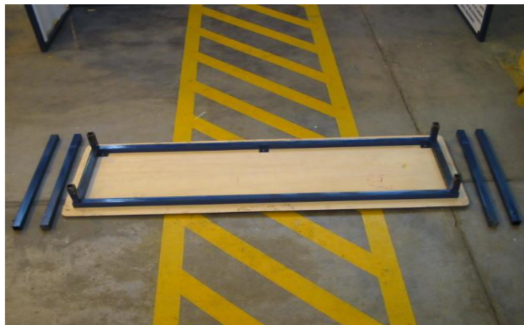
Figura 3.27 Desarmado de las patas de la mesa
