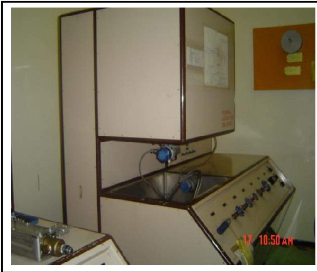
Figura 2.1 .Banco de prueba estático construido con materiales de importación.
