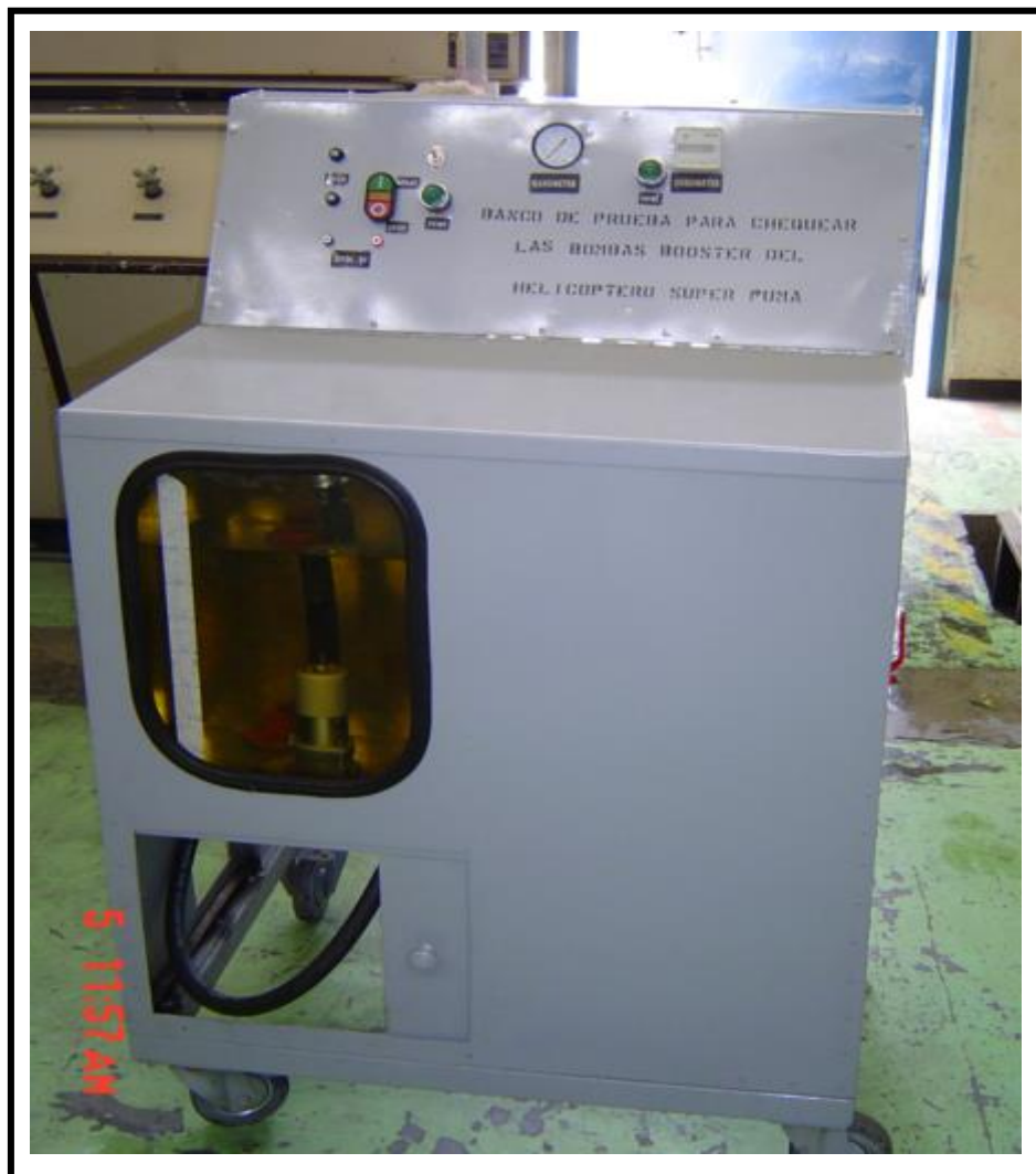
Figura 3.8.- Banco de pruebas para chequear el funcionamiento de las bombas reforzadoras (booster) del helicóptero Super Puma.
