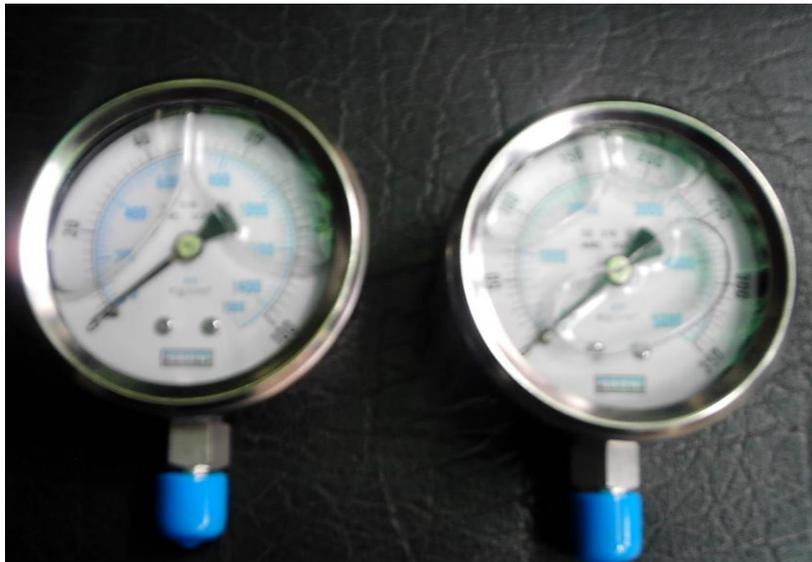
Figura 3.7. Manómetros de presión.
