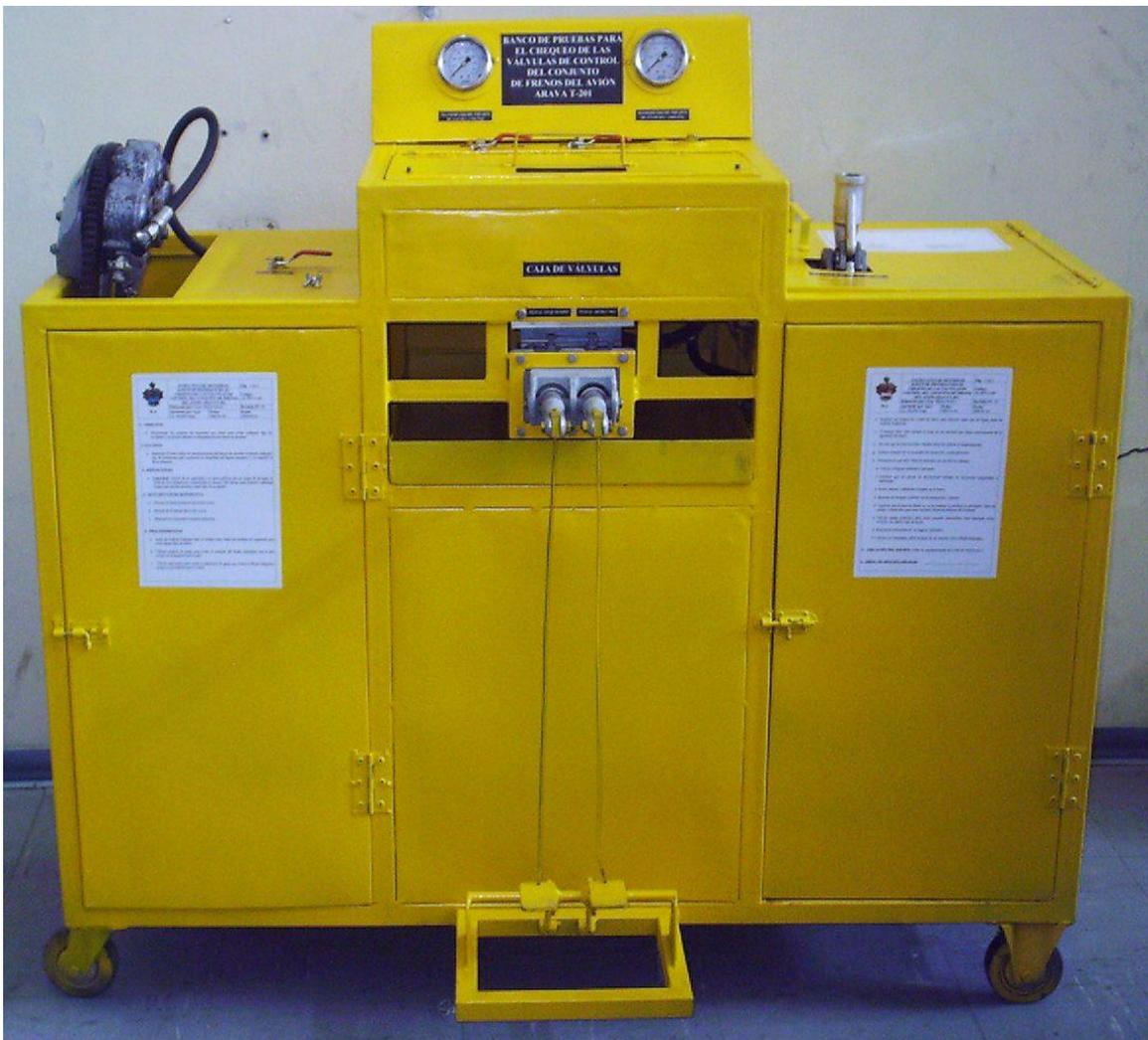
Figura 3.13. Banco de prueba para el chequeo de las válvulas de control del conjunto de frenos del avión Arava T-201.
