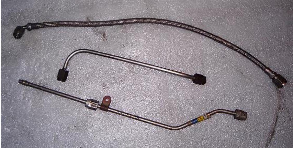
Figura 3.5. Cañerías hidráulicas.
