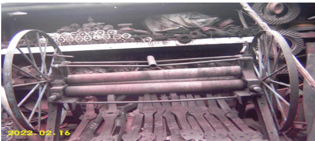
Fig. 3.1 Baroladora con sistema de transmisión por fricción
