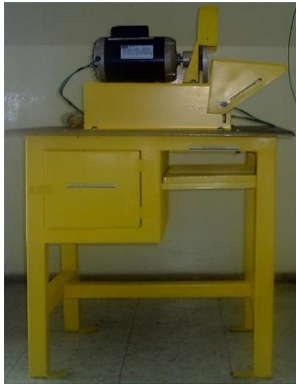
Figura 2.1.- Lijadora eléctrica con un motor eléctrico monofásico (foto Eddy Vera)
