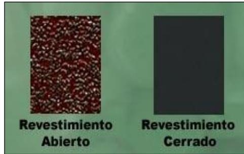
Fig. 1.85. Tipos de revestimientos (<http://bricotodo.com/lijar.php/>)
