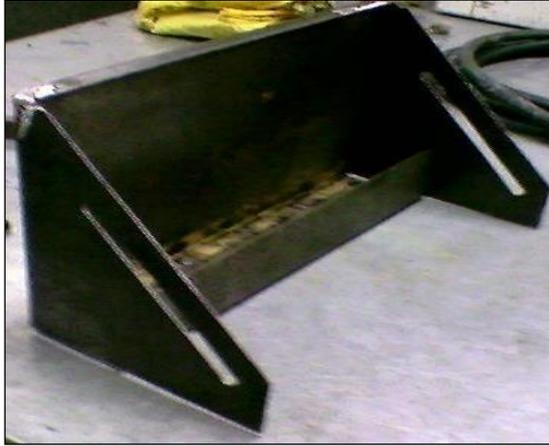
Fig.3.10.- Plano graduado hasta 45 grados II (foto Eddy Vera)
