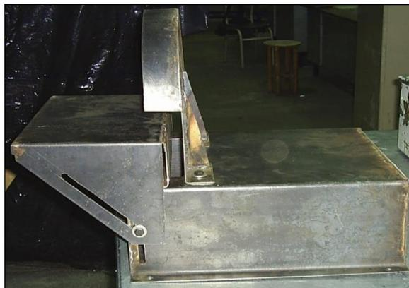
Fig. 3.1.- Estructura de la lijadora eléctrica (foto Eddy Vera)
