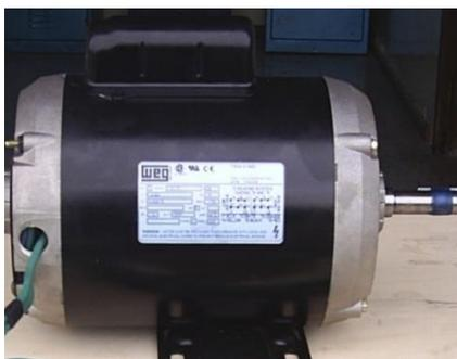
Fig.1.24. Aspecto de motor de arranque con capacitor (foto de Eddy Vera)
