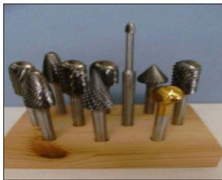
Fig. 1.75. Fresas metálicas (<http://bricotodo.com/lijar.php/>)
