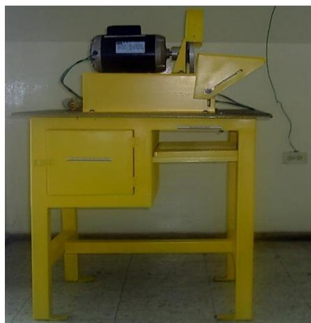
Fig. 3.13.- Lijadora eléctrica terminada (foto Eddy Vera)
