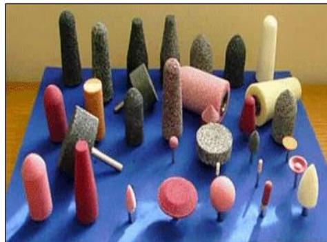
Fig. 1. 76. Muelas cerámicas (<http://bricotodo.com/lijar.php/>)
