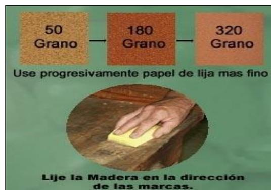
Fig. 1. 84. Manera de usar papel abrasivo (<http://bricotodo.com/lijar.php/>)
