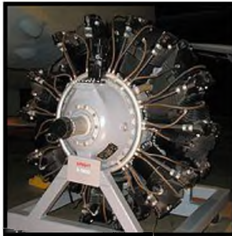
Figura 2.5 Wright R-2600, un motor radial de 14 cilindros dispuestos en dos filas Fuente: http://es.wikipedia.org/wiki/Motor_aeron%C3%A1utico
