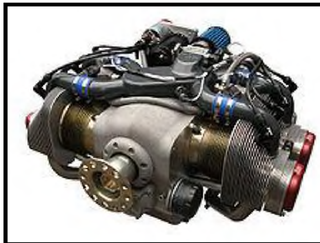
Figura 2.6 Un motor de cilindros horizontalmente opuestos refrigerado por aire. Fuente: http://es.wikipedia.org/wiki/Motor_aeron%C3%A1utico
