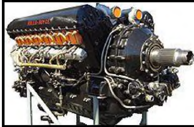
Figura 2.4 Configuración V12 refrigerado por líquido. Fuente: http://es.wikipedia.org/wiki/Motor_aeron%C3%A1utico
