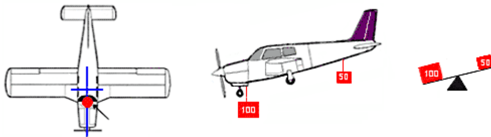
Figura 2.22 Centro de gravedad adelantado, avión pesado de morro.
