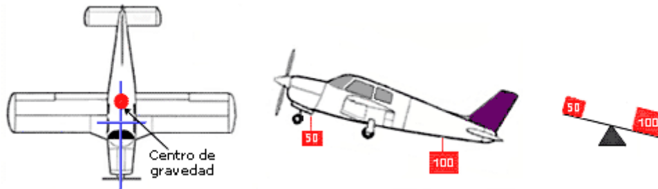
Figura 2.20 Centro de Gravedad retrasado o avión pesado de cola. Fuente: http://www.manualvuelo.com/PRE/PRE43.html
