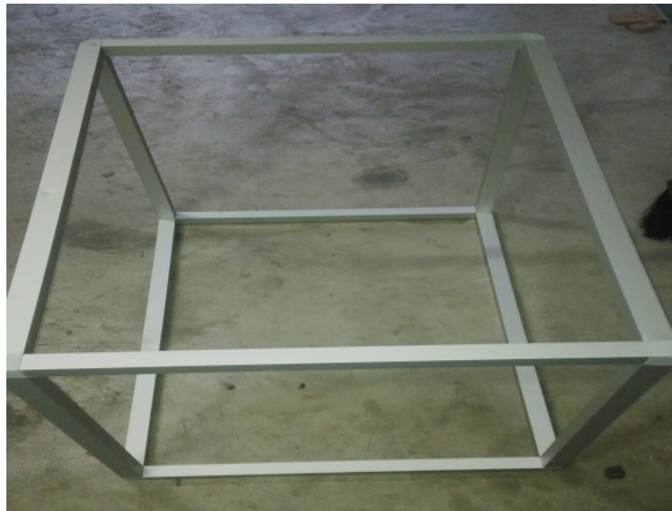
Figura 3.6 Unión de todos los esquineros con el tubo extruido Fuente: Investigación de Campo
