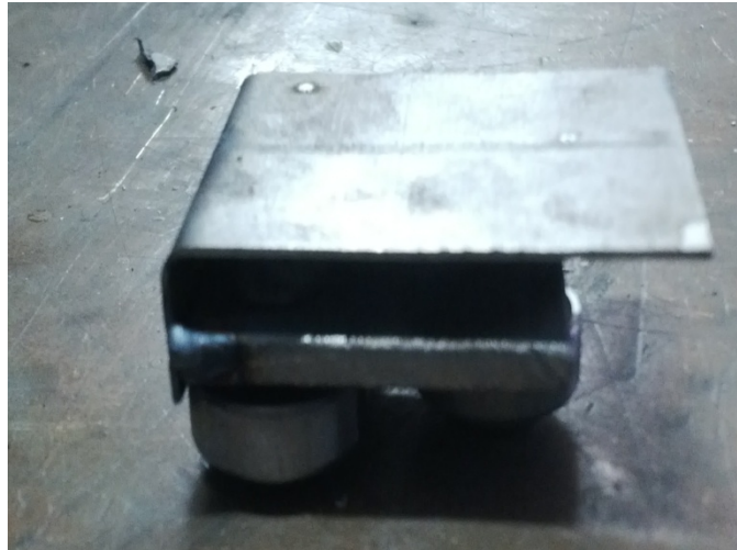
Figura 3.14 Soldadura de objetos de rodamiento. Fuente: Investigación de Campo
