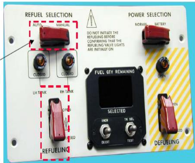
Figura 1.74.- Operación del Abastecimiento a Presión (B)
