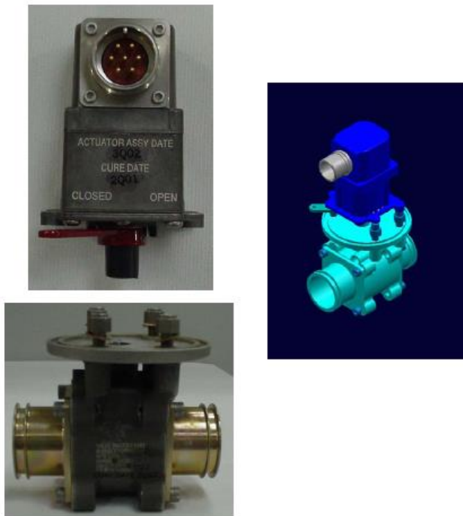
Figura 1.84.- Válvula Shut-off de Desabastecimiento
