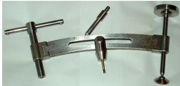
**Fig. 3.33. Herramienta Extractora de Tornillos Ensamblada**
