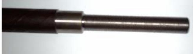
**Fig. 3.13. Tornillo Milimétrico**
