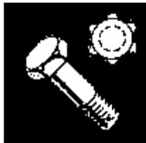
**Figura 1.12. Perno de Cabeza Hexagonal**
