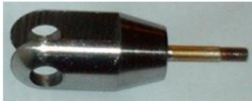
**Fig. 3.23. Ejes de Soporte Cortados y Terminados**
