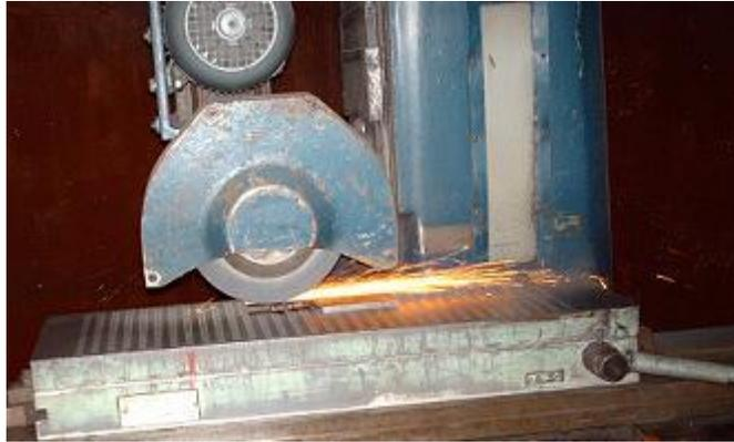
**Fig. 3.27. Rectificado del Brazo con Pie**
