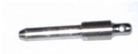
**Fig. 3.32. Pasador del Eje Terminado**
