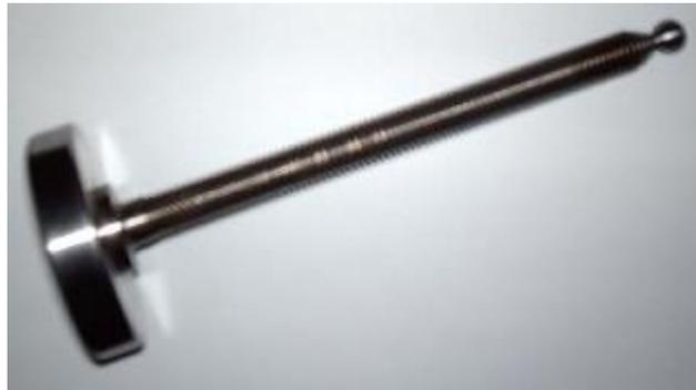
**Fig. 3.5. Mango Soldado al Tornillo Sin Fin**
