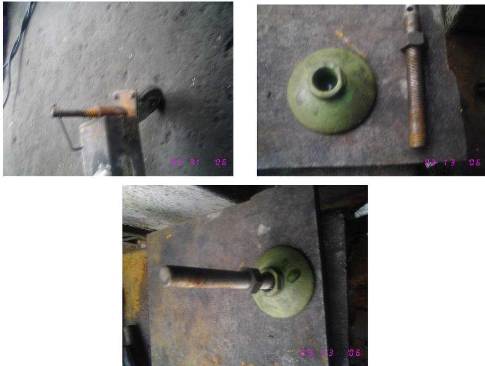
**Figura 4.8.- Ruedas y soportes para nivelar la estructura.**
