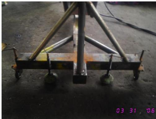
**Figura 4.4.- Soporte de la pierna del soporte móvil.**
