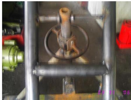
**Figura 4.5.- Volante del soporte móvil.**
