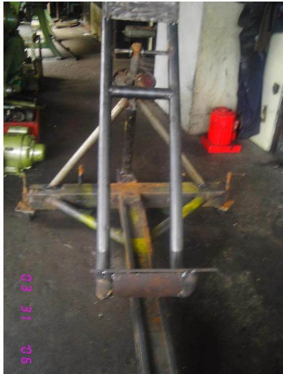
**Figura 4.1.- Estructura del soporte móvil para el tren de aterrizaje principal del avión AVRO AV 748**
