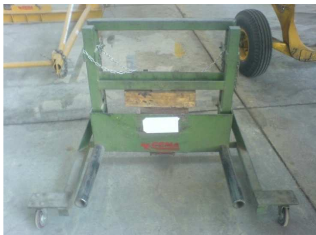
Figura 1.1 Elevador de Ruedas del Tren Principal.
