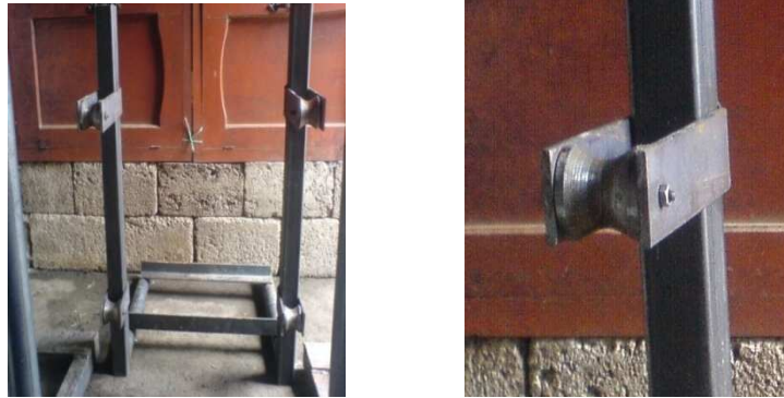
Figura 3.13 Rodillos probados en las platinas
