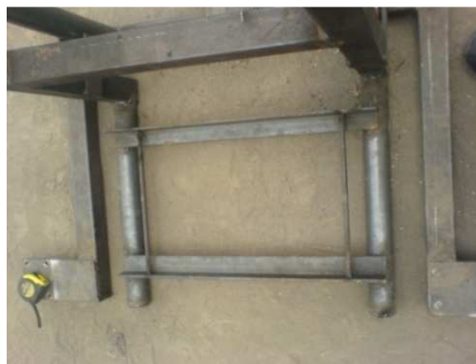
Figura 3.11 Varillas soldadas en la parte móvil del Dolly
