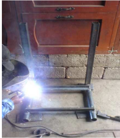
Figura 3.10 Ángulos y tubos soldados en la parte móvil del Dolly
