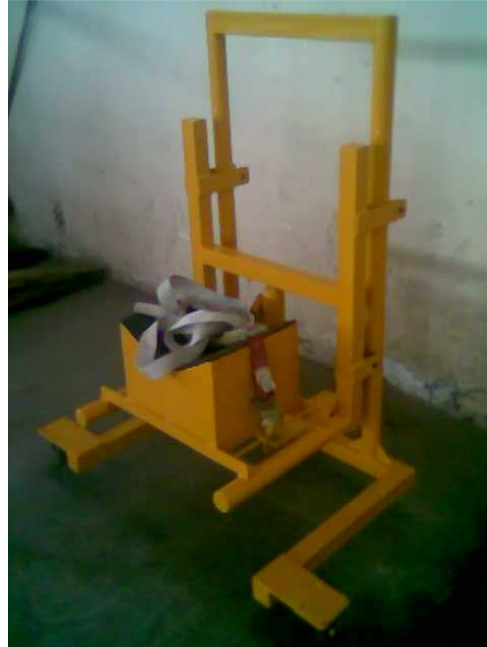
Figura 3.15 Dolly armado y terminado
