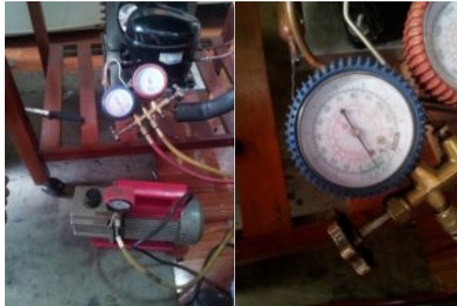
Figura 3.56: Vaciado del sistema, a la izquierda presión para extracción de -20 PSI
