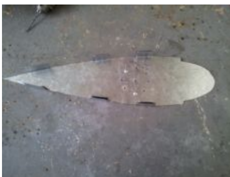
Figura 3.5: Costilla con las aletas en la parte superior e inferior
