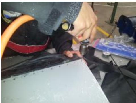
Figura 3.15: Perforación de orificios para remachado del caucho con el perfil
