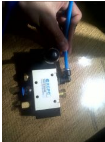
Figura 3.28: Válvula 5/2 y conexión neumática hacia las zapatas
