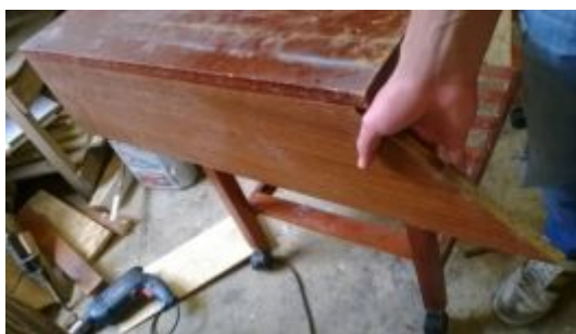
Figura 3.81: Colocación de tableros laterales
