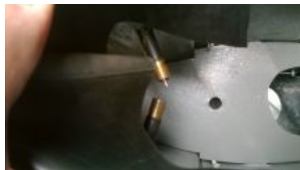
Figura 3.21: Entradas de aire a los tubos neumáticos
