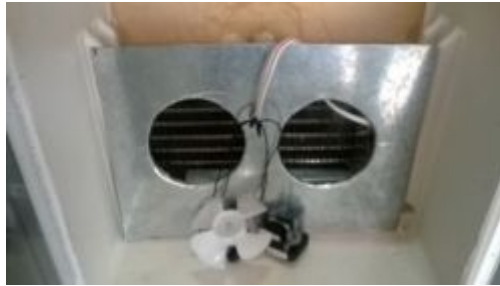
Figura 3.64: Alojamiento de ventiladores a la salida del difusor
