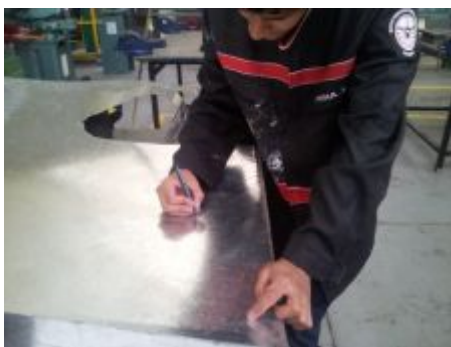
Figura 3.4: Trazado del perfil alar en plancha de acero
