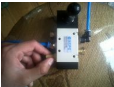
Figura 3.31: Colocación de silenciador en la tercera entrada de la válvula
