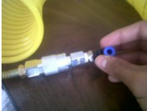
Figura 3.36: Racor para conexión con regulador de presión
