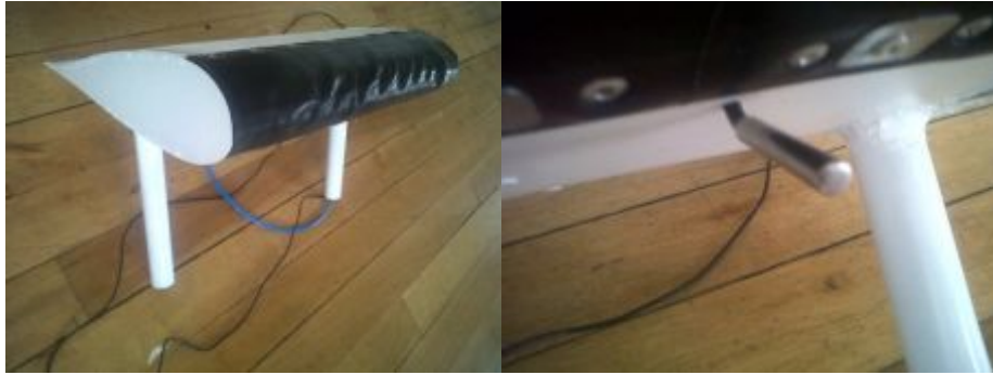
Figura 3.27: Manguera neumática (azul), a la derecha termocupla
