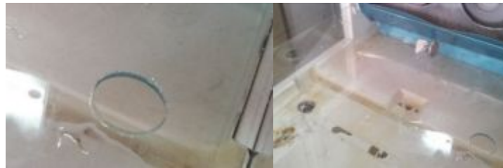
Figura 3.65: Orificios cortados en la parte central del vidrio inferior.
