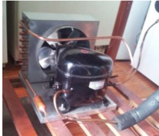
Figura 3.54: Sistema de refrigeración completo
