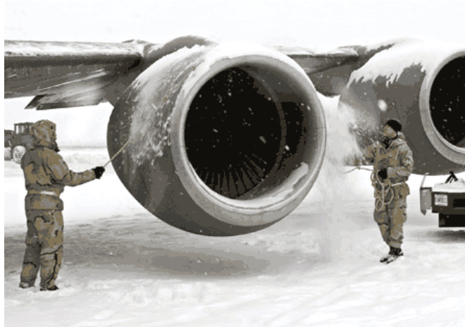
Figura 2.23: Proceso de deshielo manual de aeronave
