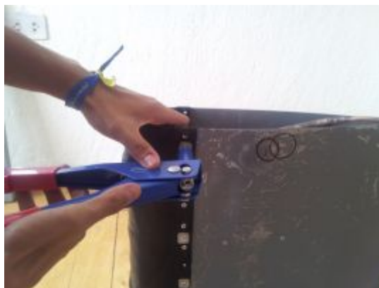
Figura 3.17: Remachado de la zapata con el perfil
