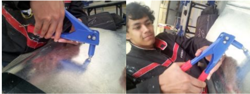
Figura 3.10: Remachado de costillas en el perfil alar
