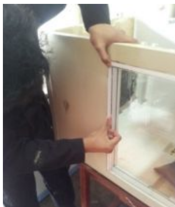
Figura 3.39: Colocación de los vidrios a la cámara por medio de silicona
