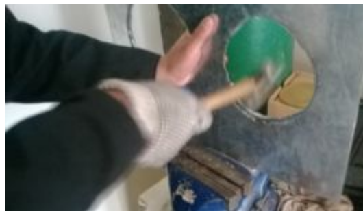
Figura 3.63: Corte de los puntos taladrados
