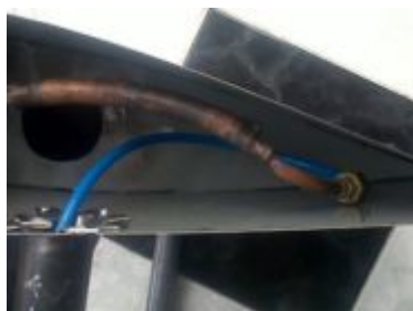
Figura 3.26: Racor conectado para salida de manguera
