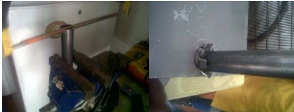
Figura 3.87: Elaboración de pestañas para los soportes
