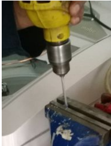
Figura 3.22: Perforación a la tapas de las válvulas
