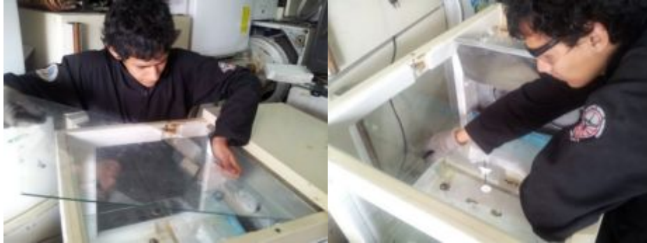
Figura 3.67: Colocación de vidrios
