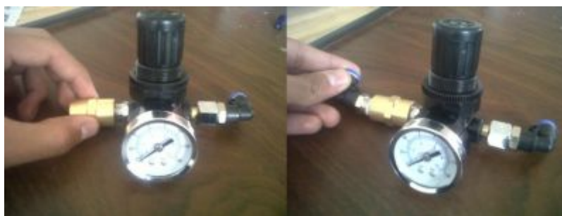
Figura 3.33: Enlace de la entrada del regulador
