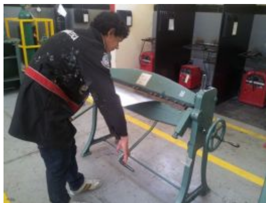
Figura 3.9: Elaboración de dobleces en la parte central
