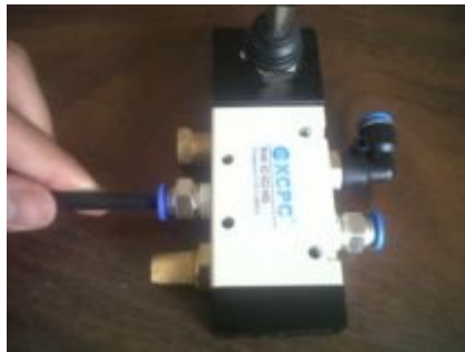
Figura 3.30: Conexión de manguera en racor de la segunda entrada de la válvula
