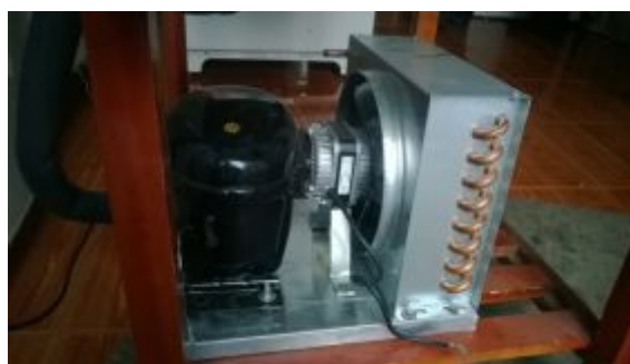
Figura 3.41: Montaje del compresor
