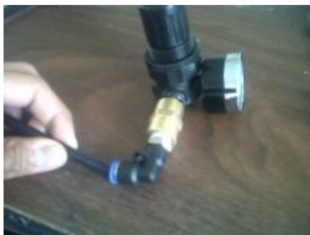
Figura 3.34: Conexión de racor y manguera de 1/4"
