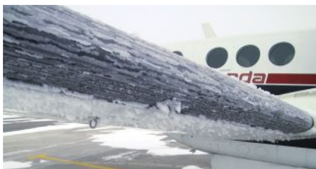
Figura 2.8: Hielo claro en borde de ataque
