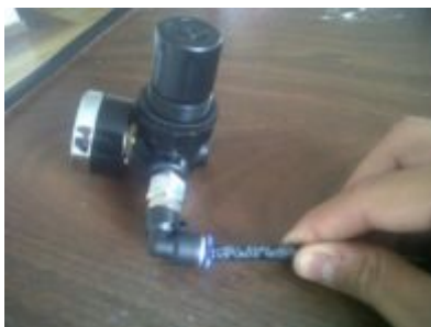
Figura 3.32: Conexión de la salida del regulador de presión
