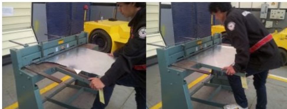
Figura 3.7: Corte de la estructura del perfil alar
