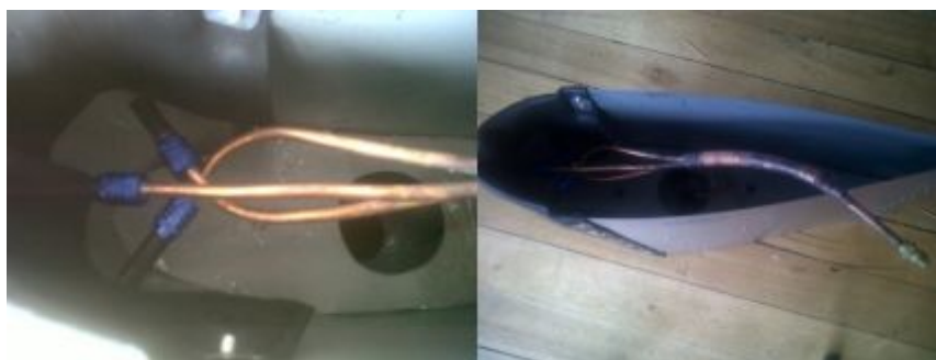
Figura 3.25: Conexión para entrada de aire
