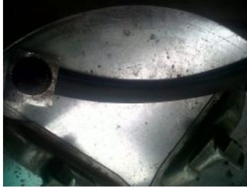
Figura 3.12: Extremo del tubo listo para vulcanizar
