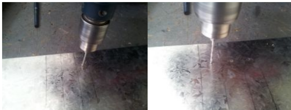
Figura 3.8: Perforación de orificios en la parte central del perfil
