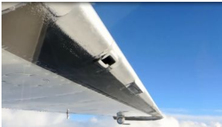
Figura 2.7: Hielo granular en borde de ataque
