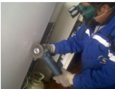
Figura 3.38: Corte de parte lateral del congelador
