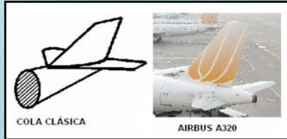
Suele ser la solución óptima desde el punto de vista de estabilidad, control y de peso estructural del conjunto
