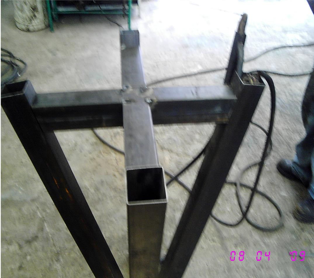
**Figura N° 6.5:** estructura principal del soporte.
