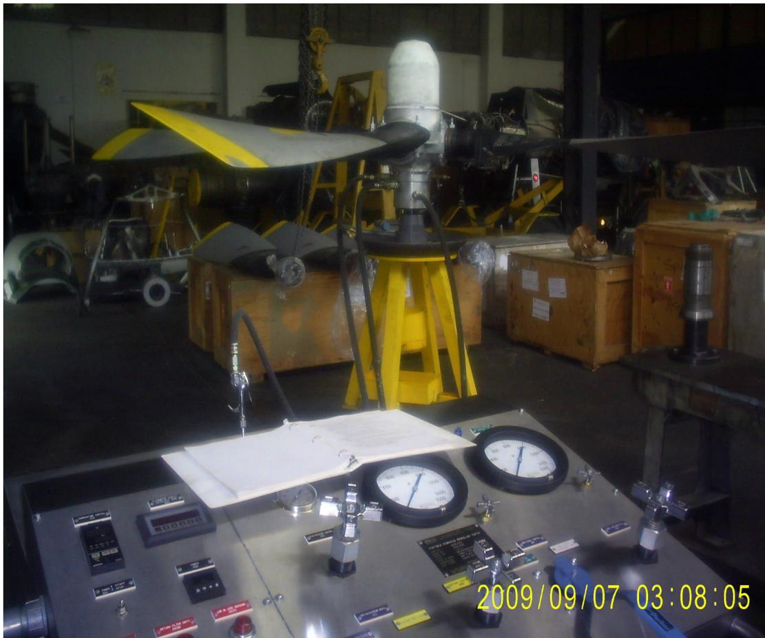
**Figura N° 6.11: Prueba del soporte con carga.**
