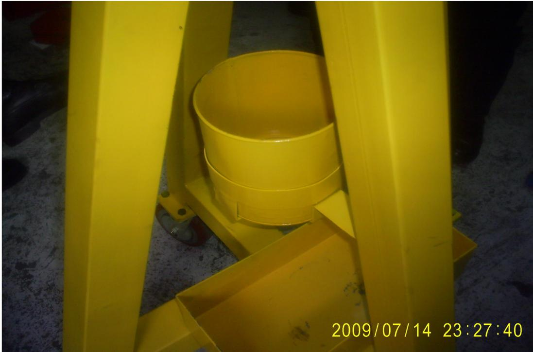
**Figura N° 6.8:** Reservorio y bandeja de herramientas.
