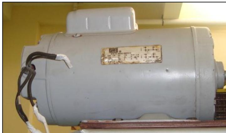
**Figura 3.2 Motor monofásico eléctrico de 2 HP.**
