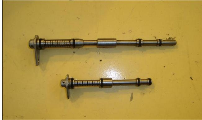
**Figura 2.29 Pulverizadores de aceite de la transmisión del helicóptero bell 206.**
