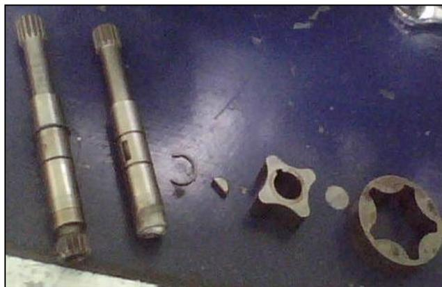
**Figura 3.10** Reemplazo del eje de la bomba de aceite.
