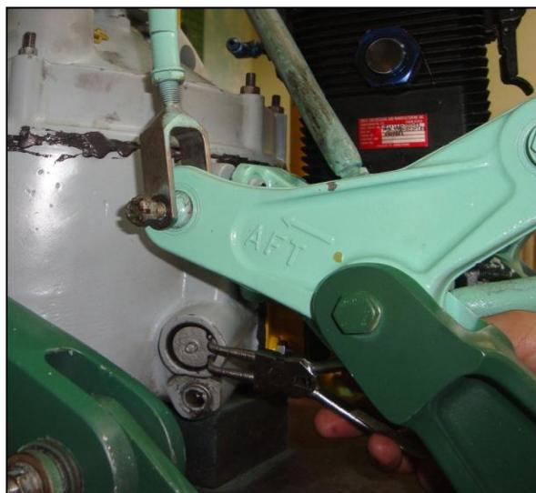
**Figura 3.18 Filtro tipo malla de la bomba de aceite.**
