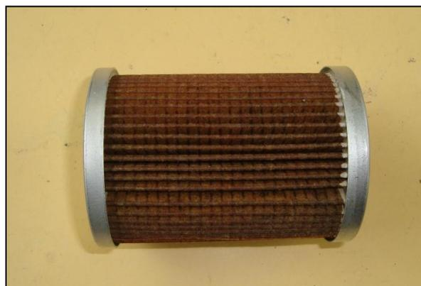
**Figura 2.28** Filtro de aceite de la transmisión del helicóptero bell 206.
