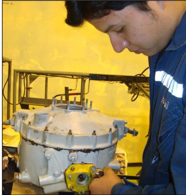
**Figura 3.17 Montaje de la bomba de aceite.**
