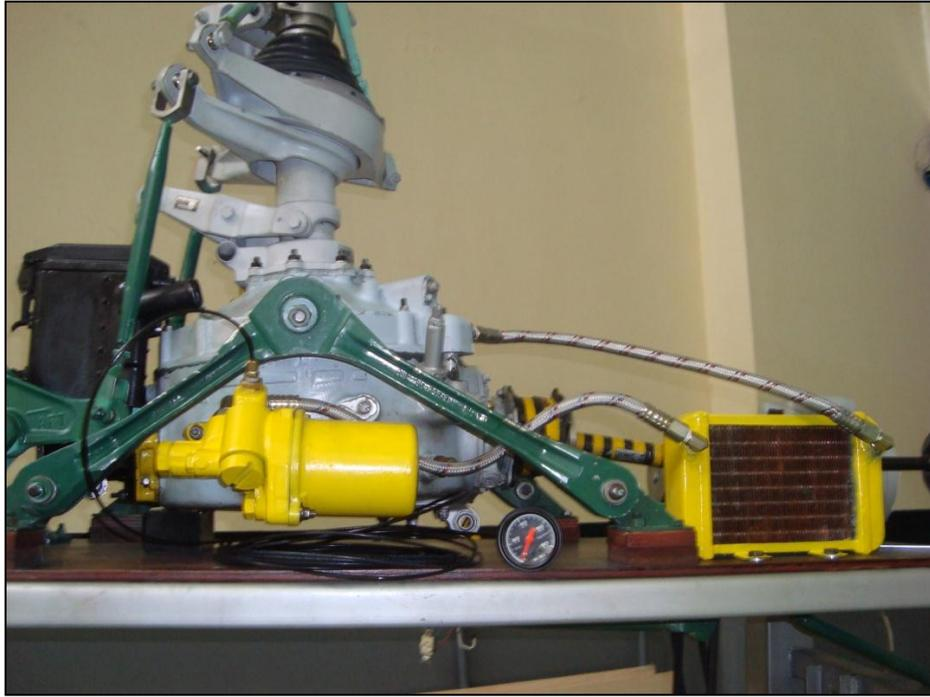
**Figura 3.27 Implementación del sistema de transmisión de aceite.**
