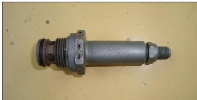
**Figura 2.30 Válvula reguladora de presión de la transmisión del helicóptero bell 206.**
