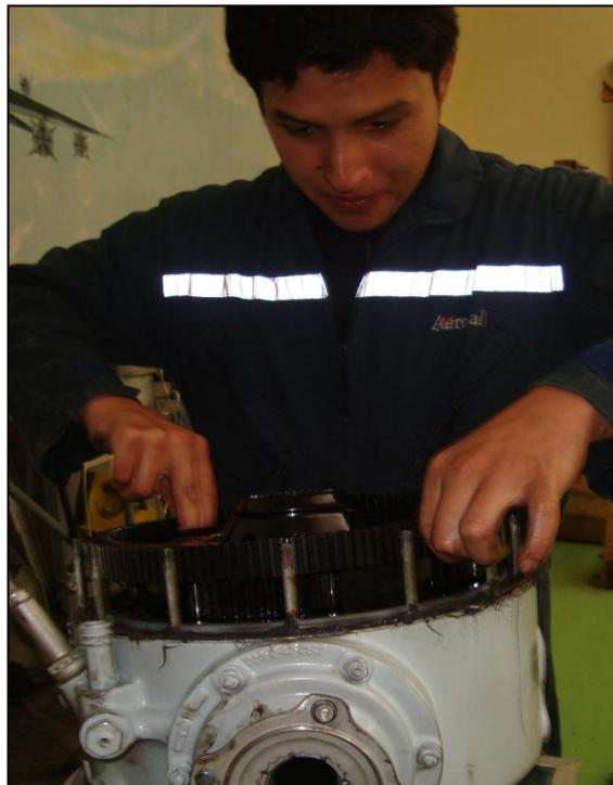
**Figura 3.15 Montaje de los engranajes de la transmisión.**
