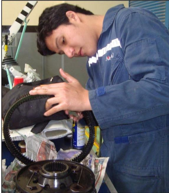
**Figura 3.14 Limpieza de los engranajes de la transmisión de aceite.**
