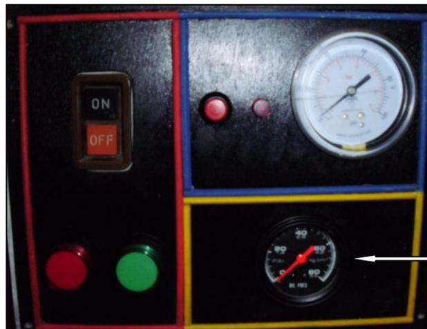
Medidor de presión del sistema de lubricación de la Transmisión
