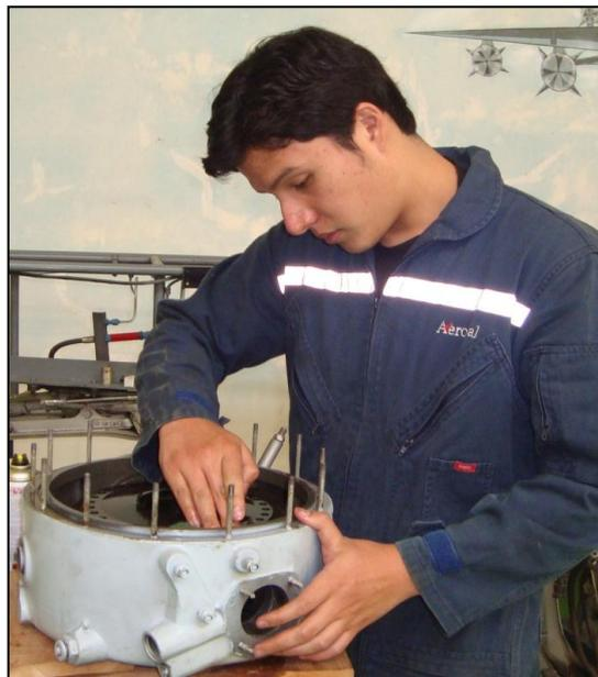
**Figura 3.13 Limpieza de la carcasa inferior de la transmisión de aceite.**
