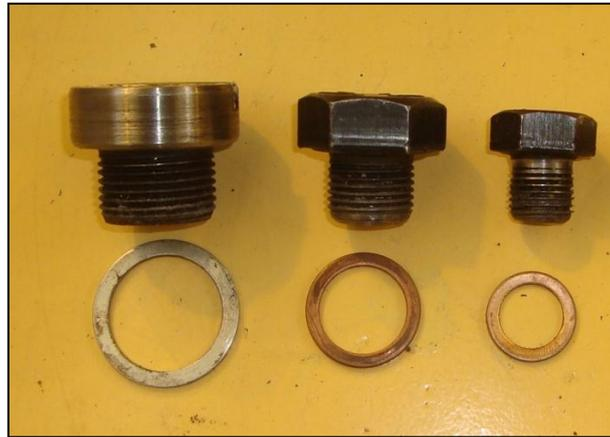
**Figura 3.19 Tapones y sellos utilizados para la cabeza del conjunto de filtro.**
