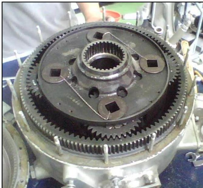
**Figura 3.12 Desarmado de la transmisión principal.**
