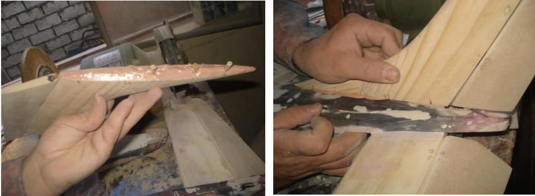
**Figura 3.13** Fijación de las superficies estabilizadoras
