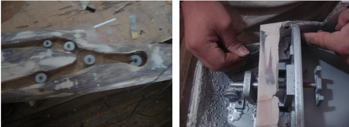
**Figura 3.19** Muestra la colocación de las poleas y el sistema de cableado
