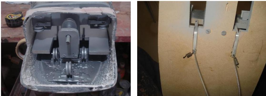
**Figura 3.16** Colocación de las poleas y los pedales en la estructura
