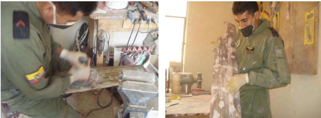
**Figura 3.2** Proceso de pulido masillado y lijado de las alas
