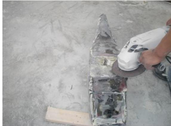
**Figura 3.11** Aplicación de la resina y pulida del fuselaje
