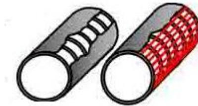
**Figura 2.4** Fuselaje Monocasco
