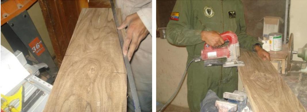
**Figura 3.1** Trazado y cortado de las alas
