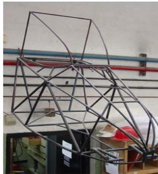
**Figura 2.3** Fuselaje Recticular
