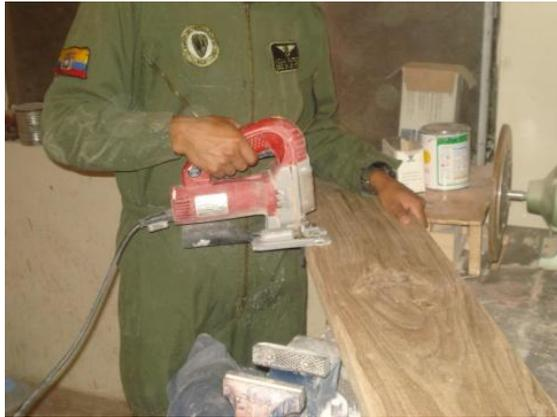
**Figura 3.5** Trazado y cortado del estabilizador horizontal
