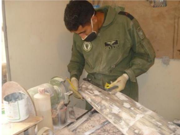
**Figura 3.3** Trazado y cortado de los alerones
