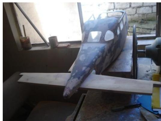
**Figura 3.12** Proceso final de la construcción y corte de puerta y ventanas
