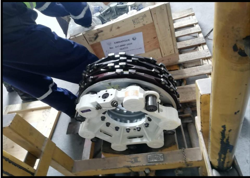
Colocar el freno de modo que el puerto de purga esté en la parte superior e instale los pernos de montaje del freno de la siguiente manera:
