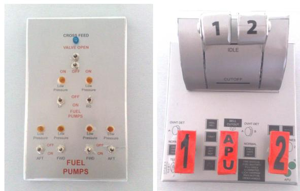
**Fig.3.3 Simulación de paneles P5, Start Levers, P8-1**
