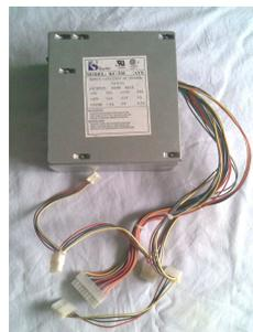
**Fig.3.7 Fuente de Voltaje**
