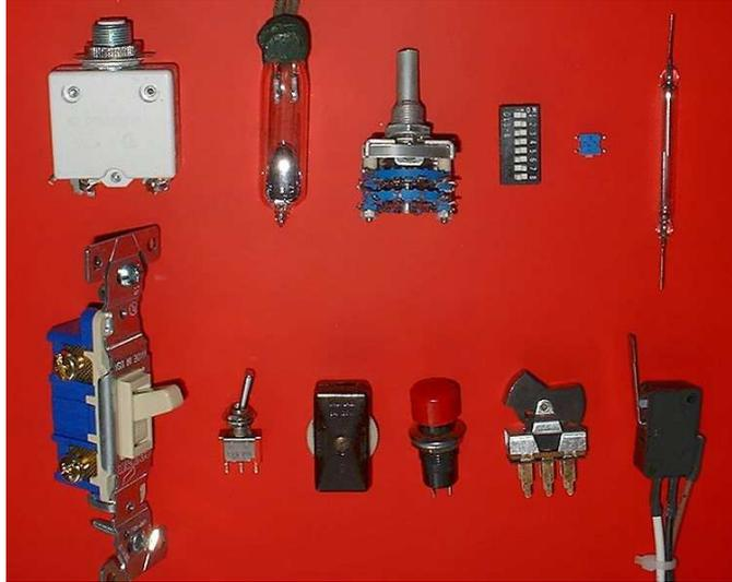
**Fig. 2.11 Tipos de Interruptores**
