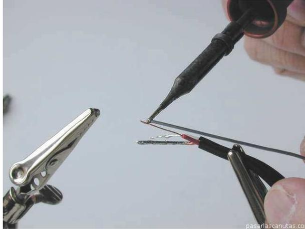
**Fig. 2.9 Soldadura con Estaño**
