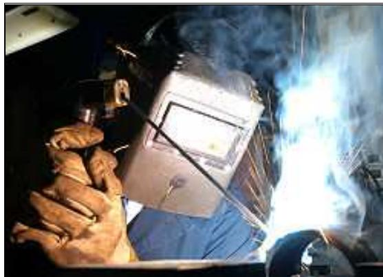
**Fig. 2.8 Soldadura por Arco**
