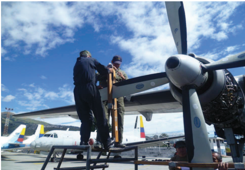
Figura 3.9 Aplicando fuerza para su embanderamiento
