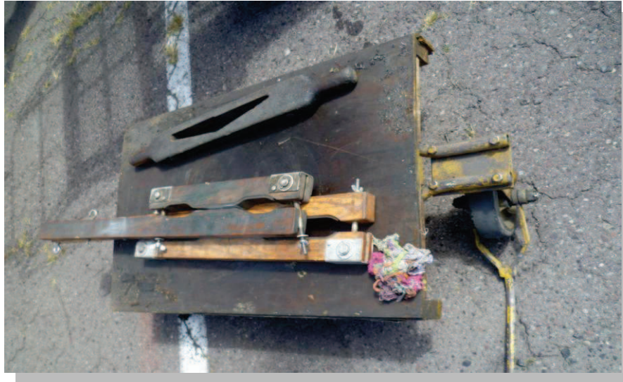
Figura 3.5 Palancas para embanderar la hélice
