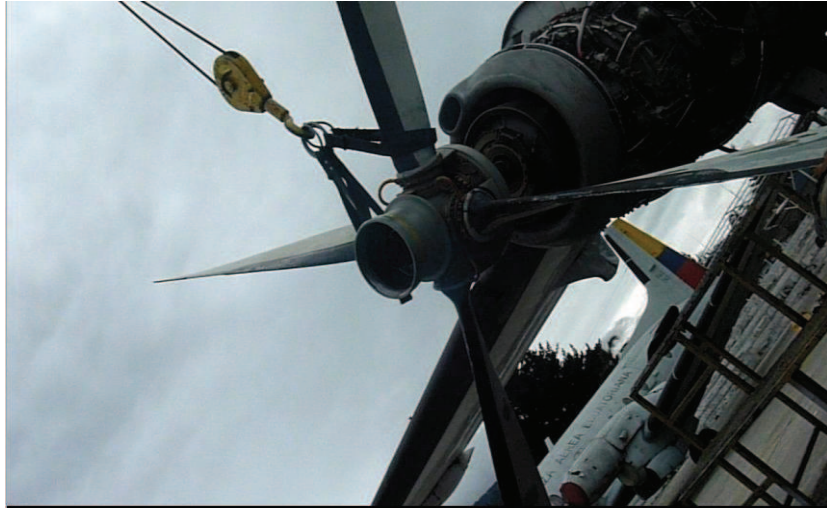
Figura 3.32 Desmontando la hélice del eje del motor
