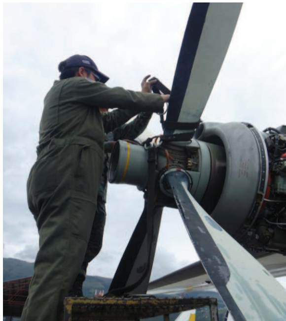
Figura 3.26 Colocando las eslingas
