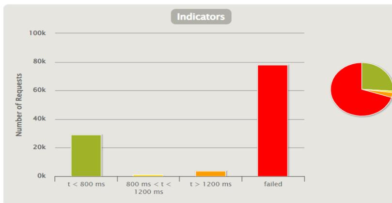
Como se observa en la Figura 87 se ha sometido al sistema a una carga de 100000 usuarios y un total de 140000 peticiones, de las cuales se tiene un porcentaje de falla del 77.46% correspondiente a 108450 peticiones y un tiempo promedio de respuesta de 7.98 segundos
