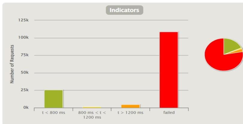
En la Tabla 8 se observa el resumen de los datos adquiridos de las pruebas de carga realizadas por medio de la herramienta Gatling, en donde se aprecia que al aumentar el número de usuarios y peticiones hacia el servidor web existe una mayor tasa de peticiones fallidas y por ende un mayor tiempo de respuesta.
