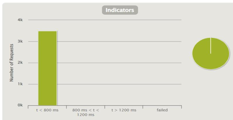
En la Figura 82 se observa el resultado de cargar el sistema con 500 usuarios y un total de 7000 peticiones, de las cuales se obtiene un tiempo promedio de respuesta de 247ms y un porcentaje de error del 0.014% correspondiente a una petición fallida.
