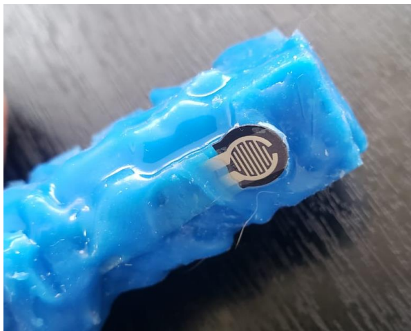
Ubicación del Sensor en Actuadores Blandos (Dedos)
