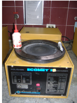
Figura 4.2 Pulido con pasta de diamante y aceite SAE-10
