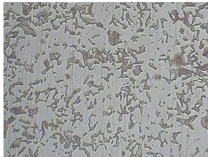
Figura 4.6 Micrografía acero ASTM A-36 50x
