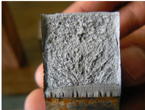
Figura 4.14 Superficie de fractura acero ASTM A 36 a bajas temperaturas
