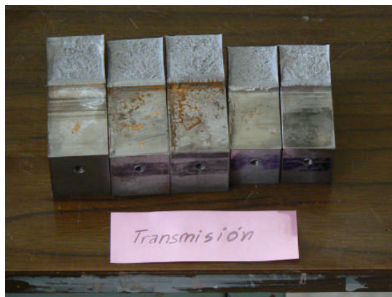
Figura 4.12 Superficie de fractura acero AISI 1045
