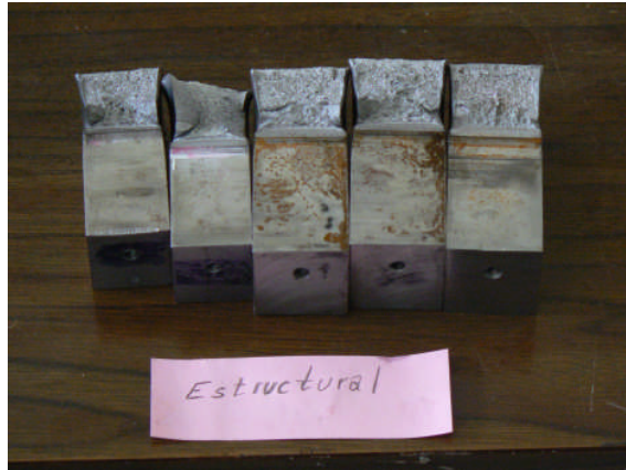
Figura 4.13 Superficie de fractura acero ASTM A 36
