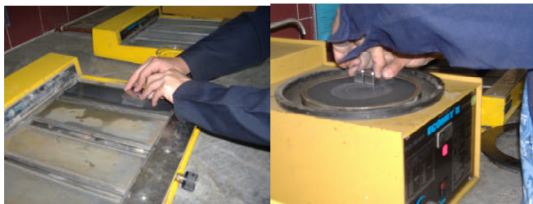
Figura 4.1 Pulido de muestra con lijas 240-600
