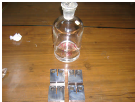
Figura 4.4 Ataque químico con Nital al 3%
