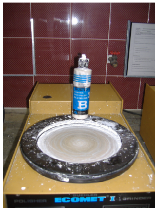
Figura 4.3 Pulido con alúmina y agua destilada
