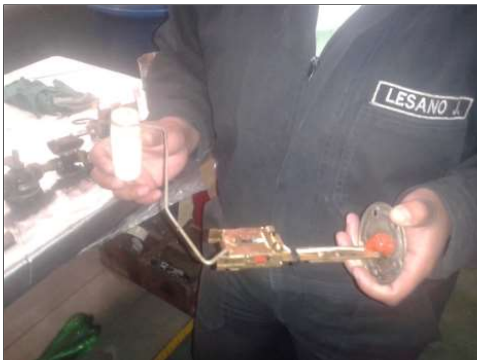
Figura 3. 12 Reinstalación del transmisor de nivel de combustible P/N 704A.67.0040.00
