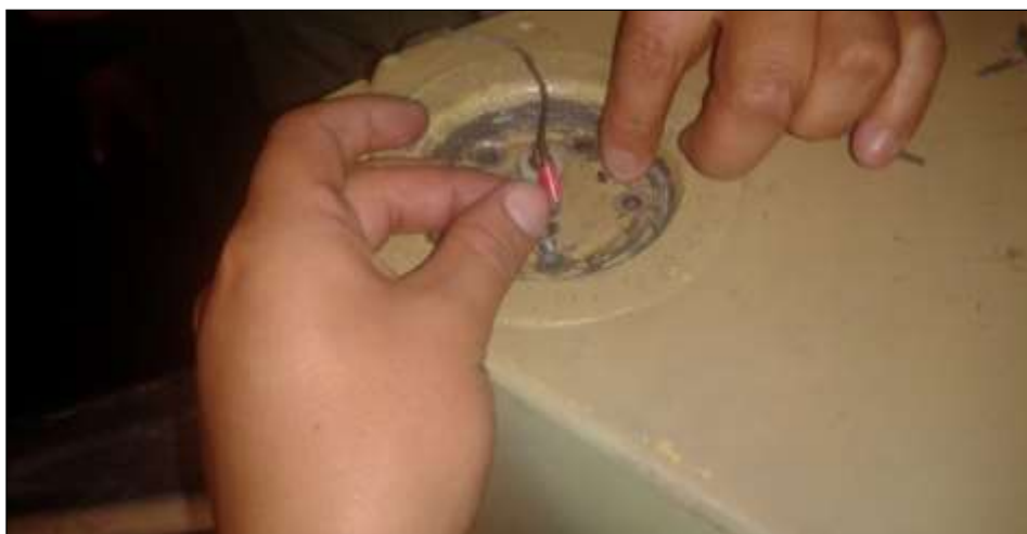
Figura 3. 11 Desinstalación del transmisor de nivel de combustible
