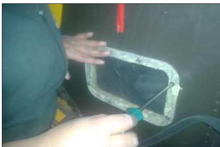
Figura 3. 24 Instalación de la mica con sus respectivos pernos.
