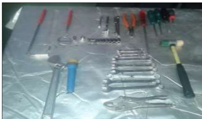
Figura 3. 5 Herramientas utilizadas en la rehabilitación de los componentes del sistema auxiliar de combustible.
