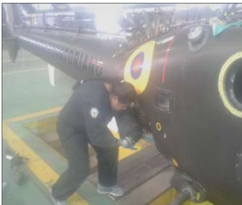
Figura 3. 22 Colocación y conexión del sumidero con N/P341A55-1065-27 en la aeronave
