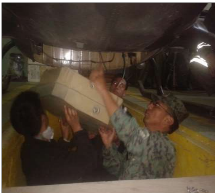
Figura 3. 16 Sujeción del tanque en la parte superior de la estructura central de la aeronave.
