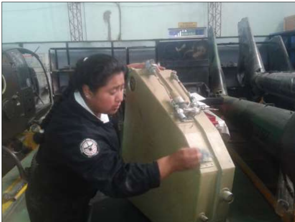
Figura 3. 10 Limpieza exterior del tanque auxiliar del sistema de combustible
