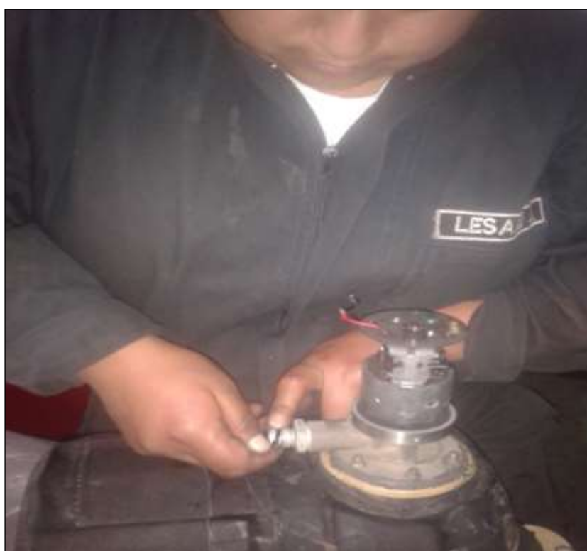
Figura 3. 20 Colocación De Sellos
