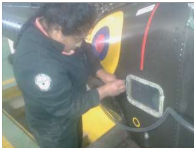
Figura 3. 23 Instalación de la tapa se acceso al sumidero.
