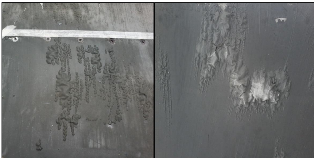
Figura 3. 18. Efecto del removedor de pintura
