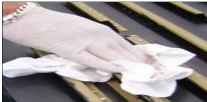
Figura 3. 21. Aplicación de emulsión limpiadora
