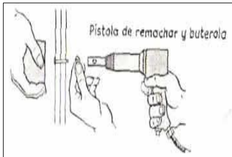
Figura 2. 13. Preparación para instalar un remache Hi-Shear con una pistola de remachar y una búmerola
