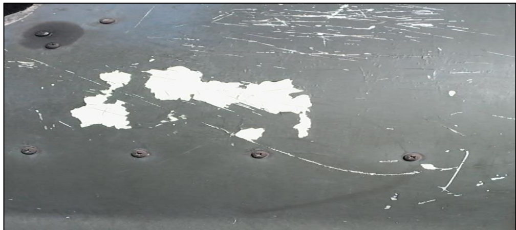
Figura 3. 7. Rayones en la pintura
