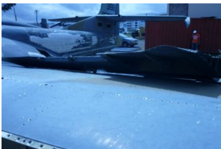
Figura 17: TAB del alerón desprendido y deformado.
