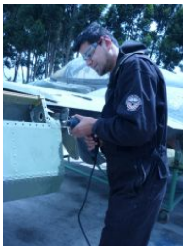
Figura 36: Proceso de desmontado del TAB TRIM alerón.
