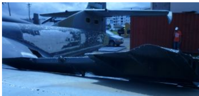
Figura 27: TAB TRIM ALERÓN deformado en un extremo.
