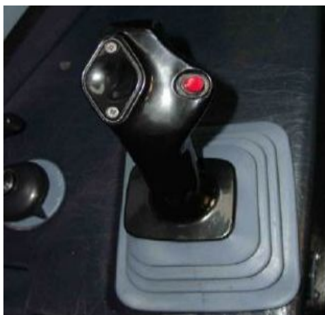
Figura 11: Sistema de mando del TRIM.
