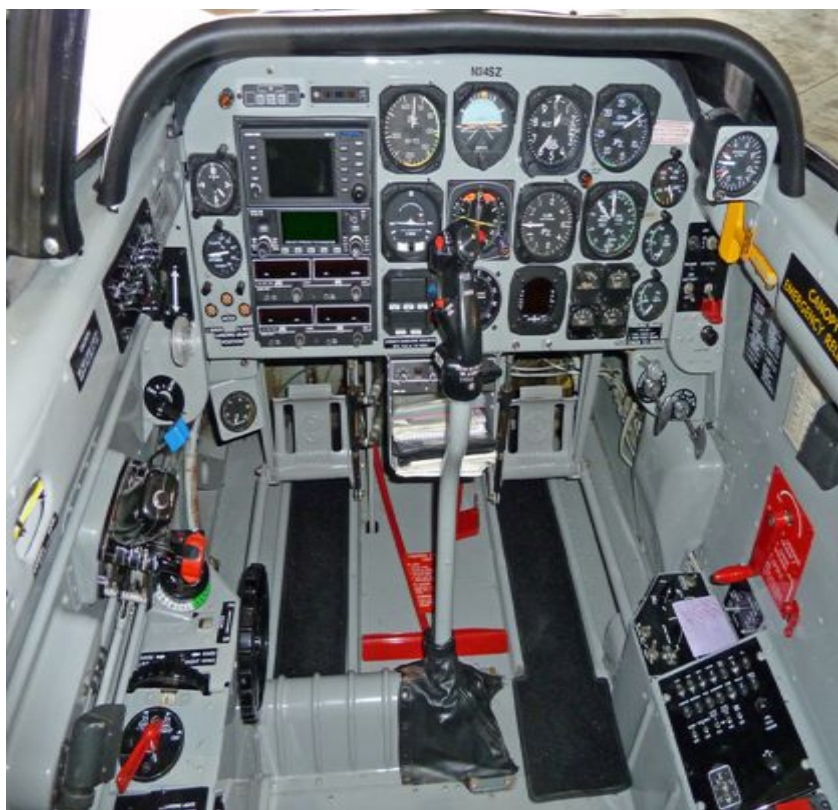
Figura 6: Mandos de control del T34 C1.
