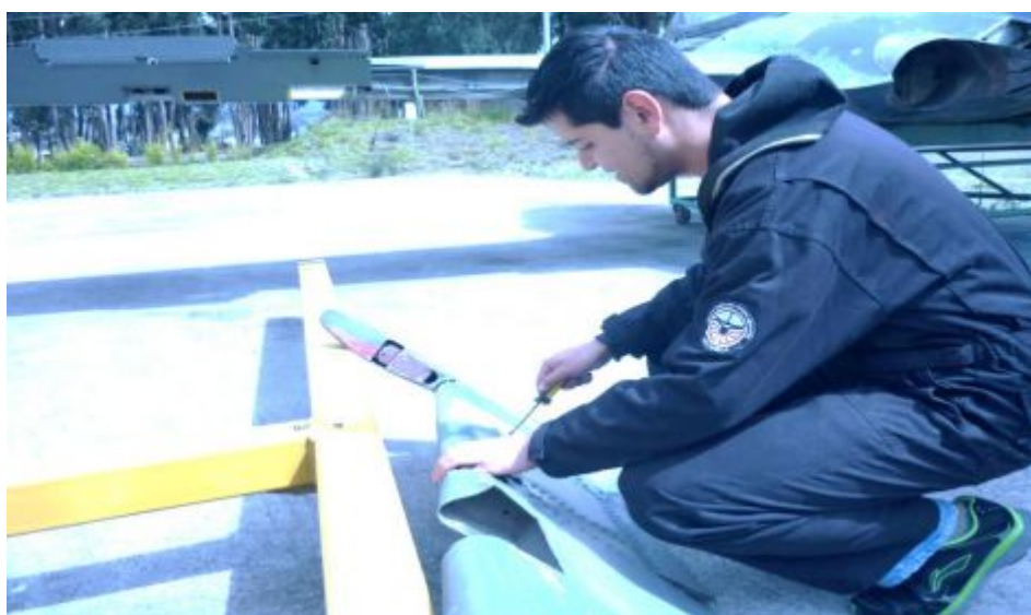
Figura 21: Desmontaje del actuador TAB TRIM.
