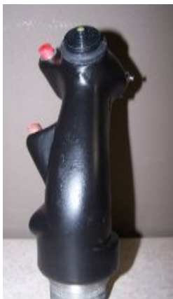
Figura 41: Control de mando de los TAB TRIM.
