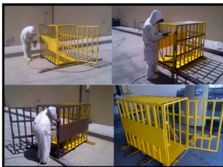
Figura 39. Pintado de la estructura
