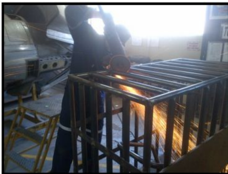
Figura 38. Pulido de la estructura
