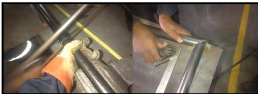
Figura 32. Corte y encuadrado de tubos
