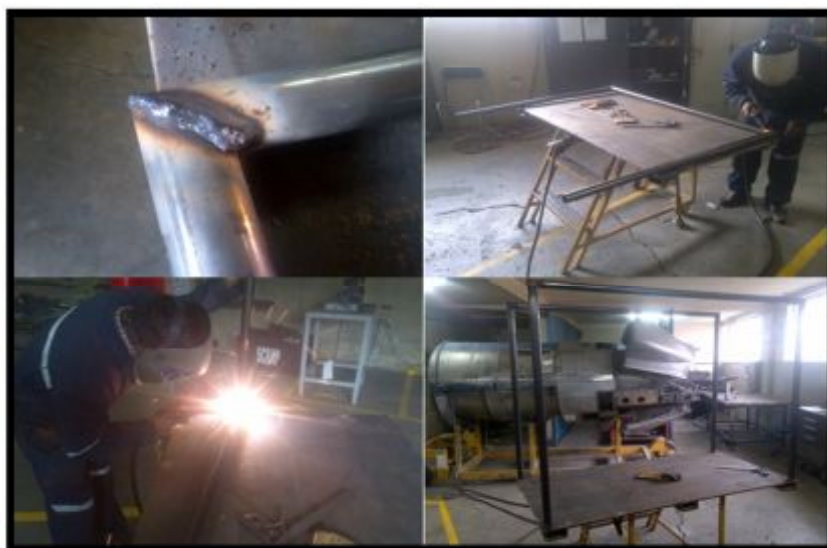
Figura 33. Soldadura y formación marcos
