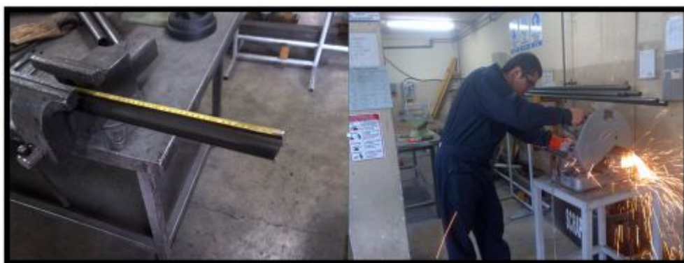
Figura 31. Medición y corte de tubos de acero
