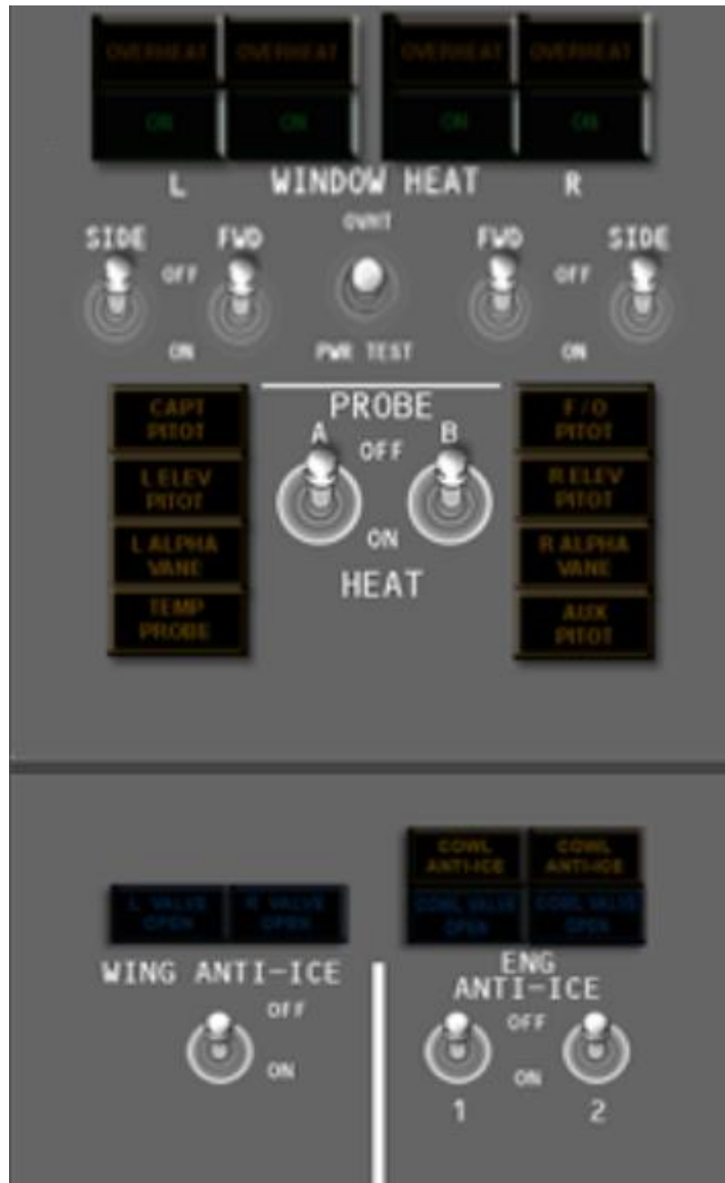
Figura 32: Panel de protección de hielo y lluvia.
