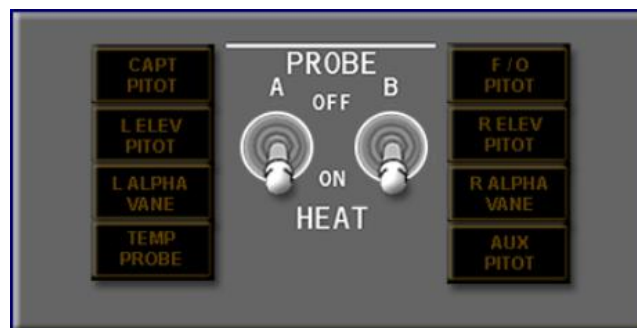
Figura 36: Operación de los Interruptores de Calentamiento de los Tubos PITOT.
