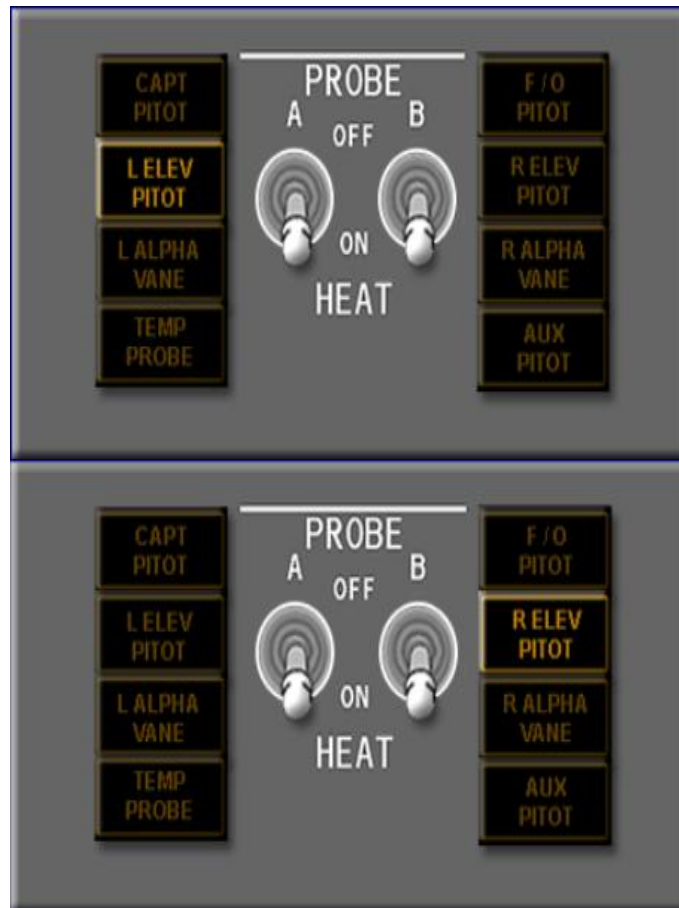
Figura 38: Operación de los Interruptores de Calentamiento de los Tubos PITOT.
