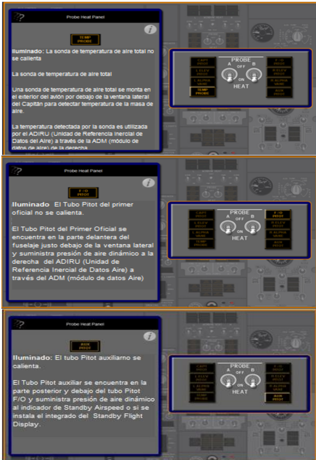
Figura 39: Operación de los Interruptores de Calentamiento de los Tubos PITOT.
