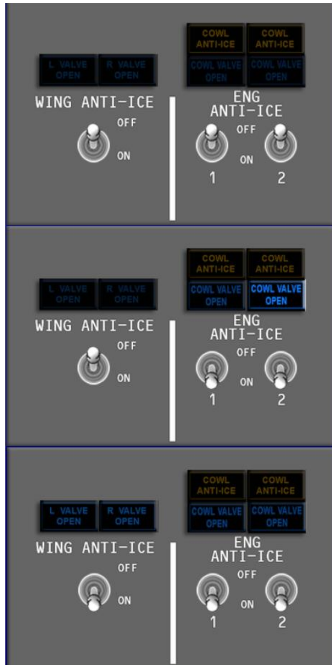
Figura 40: Operación de los Interruptores de Anti – Hielo de las Alas.
