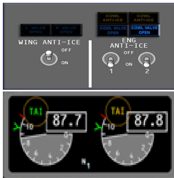
Figura 42: Operación de los Interruptores de Anti – Hielo de las Alas.
