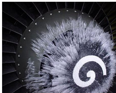
Figura 13: Formación de hielo en el SPINER de un motor JETT.
