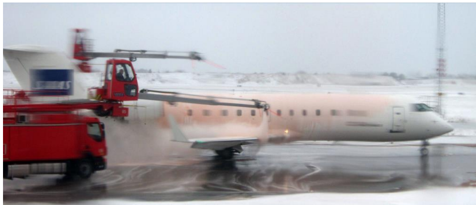
Figura 16: Sistema químico de anti hielo.
