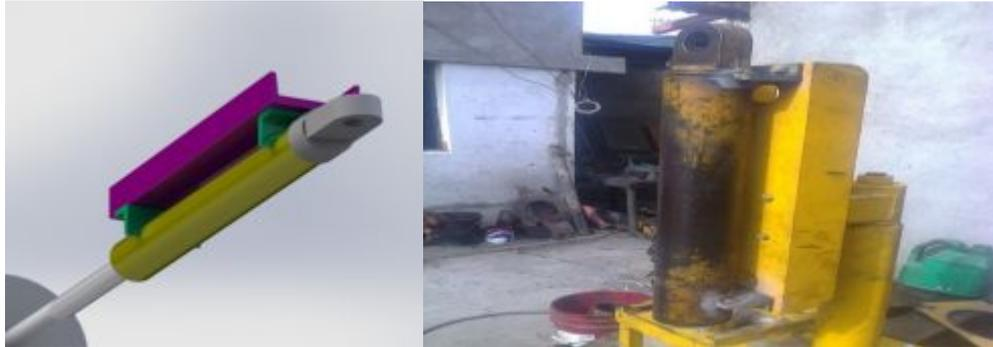
Figura 74. Comparación entre el diseño y el ensamble real.
