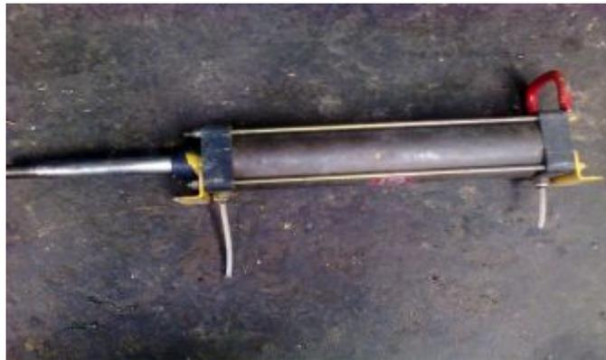
Figura 46. Cilindro Neumático desmontado.
