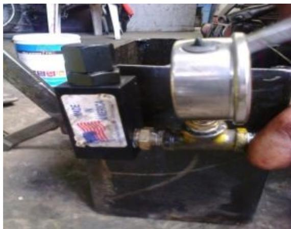
Figura 71. Válvula de alivio ajustada y asegurada.
