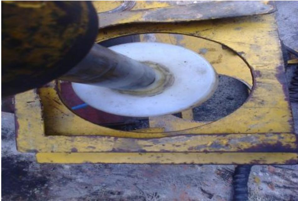
Figura 78. Centrado del pistón a la prensa.
