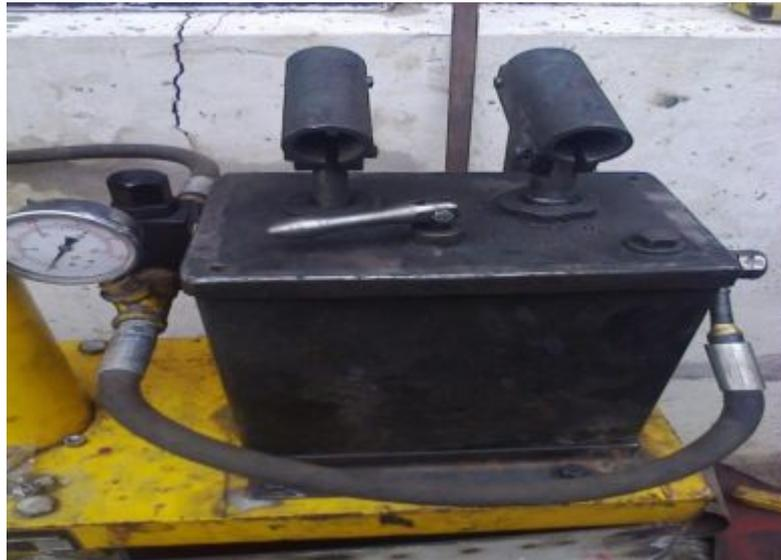
Figura 83. Bomba adaptada a la prensa.
