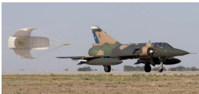
Figura.3. Paracaídas de frenado.
