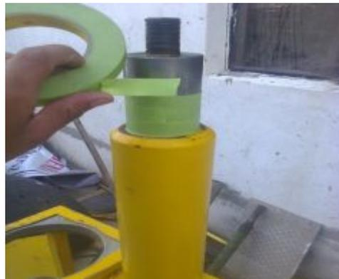
Figura 89. Proceso de protección de partes críticas.
