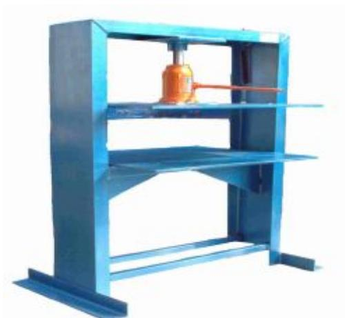
Figura 24. Prensa Hidráulica Manual.
