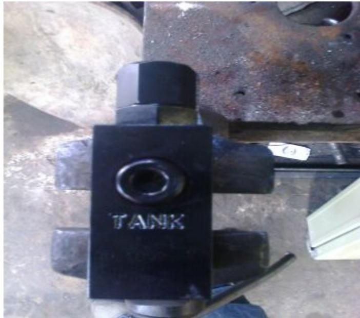
Figura 70. Línea de descarga de presión válvula de alivio.
