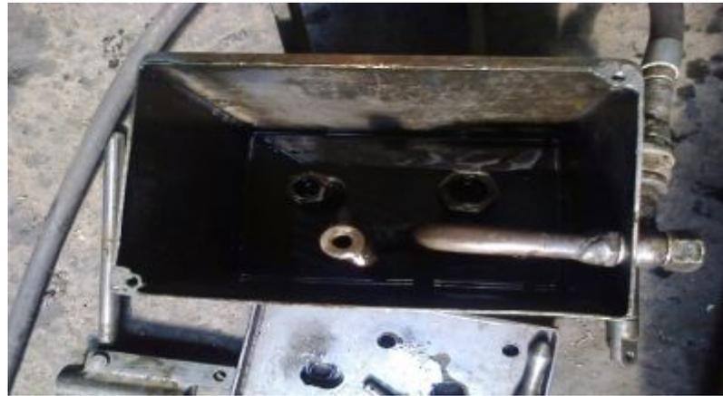
Figura 60. Orificios aspirantes de líquido hidráulico.
