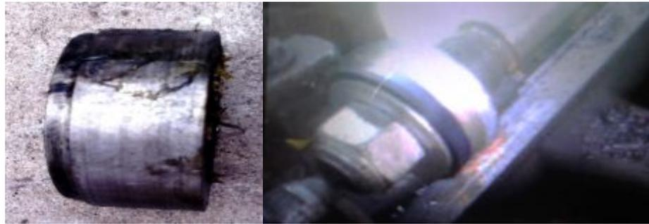
Figura 56. Pistón previo a la modificación, y pistón con empaque.
