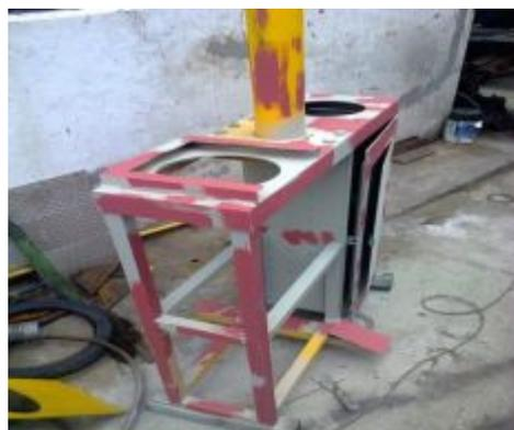
Figura 90. Proceso de masillado de la estructura.
