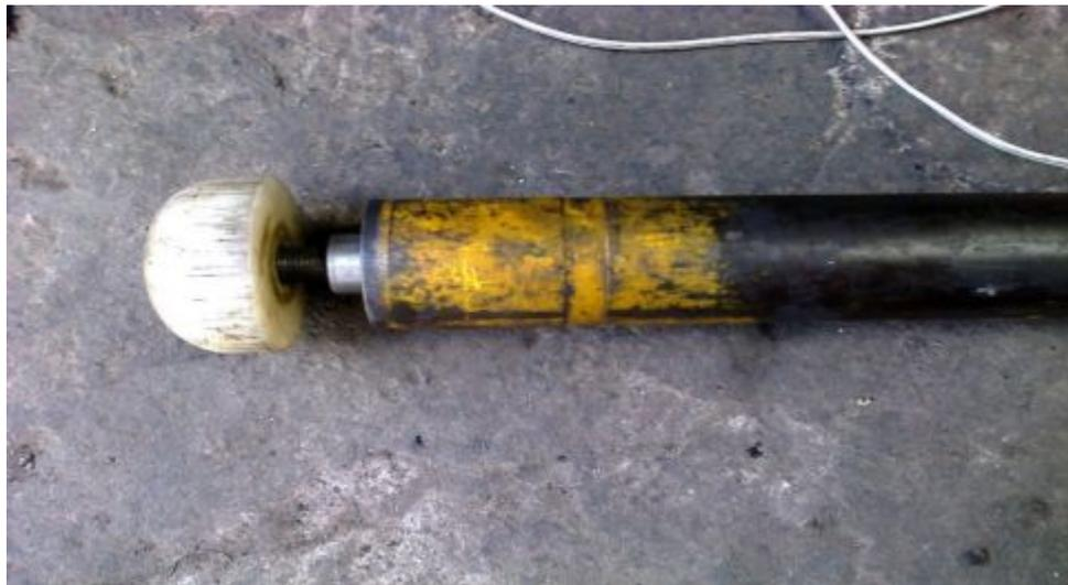
Figura 57. Actuador Hidráulico de doble efecto.
