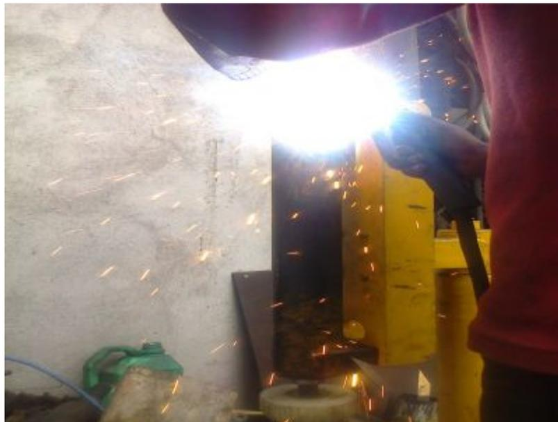
Figura 79. Proceso de soldado del cilindro.
