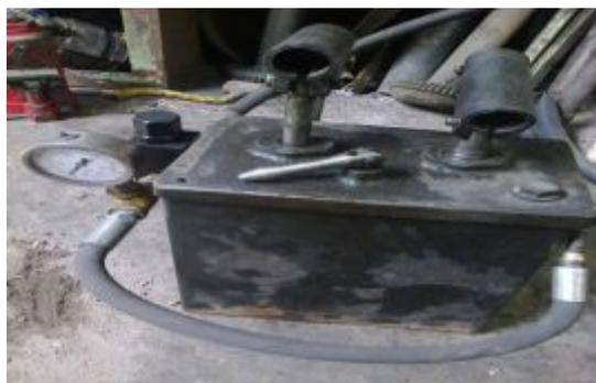
Figura 67. Bomba Reservorio.
