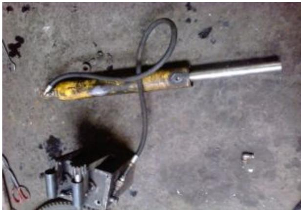
Figura 72. Bomba y cilindro unido mediante acoples y manguera flexible.
