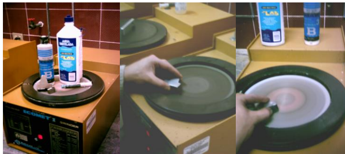
Figura 3.9: Materiales, equipos y proceso de pulido espejo.
