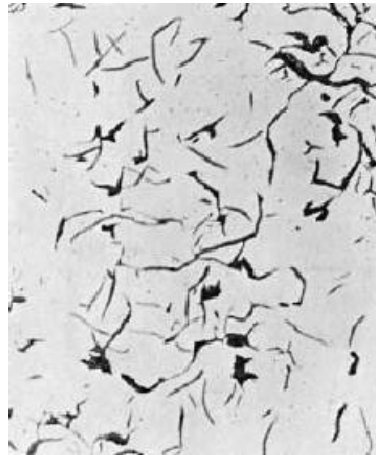
Figura 2.2: Las hojuelas de grafito eutéctico aparecen en esta fotomicrografía de color negro, y es común de que la fractura de la fundición gris se dé a través de las líneas que forman estas.
