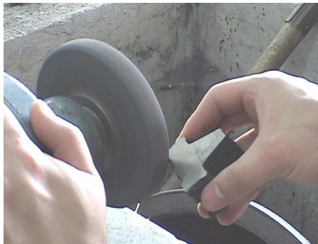
Figura 3.7: Desbaste de rebaba con piedra de esmeril.
