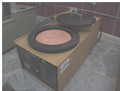
Figura 3.10: Equipo para brillado con disco de seda.
