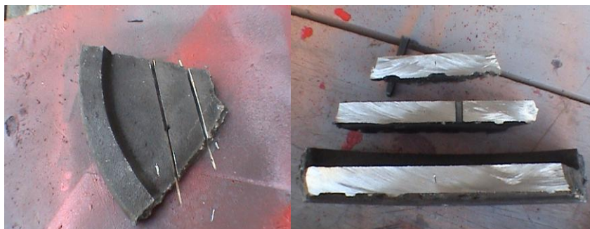
Figura 3.5: Corte de probetas de la tapa de pozo de inspección.
