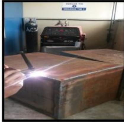
**Figura 23.** Soldadura del reservorio.
