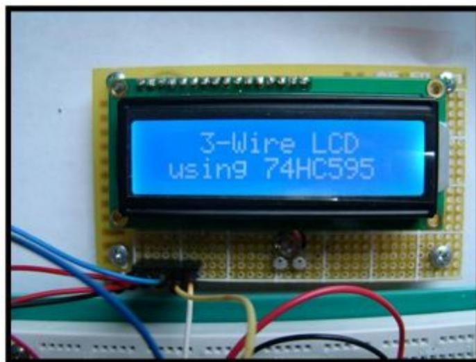
**Figura 14.** Módulo Lcd Electrónico.
