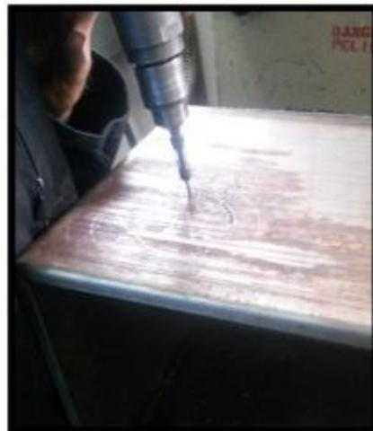
**Figura 24.** Perforación de la lámina.
