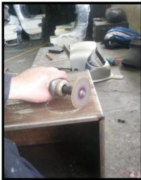
**Figura 25.** Elaboración del ingreso del capacitor al reservorio.
