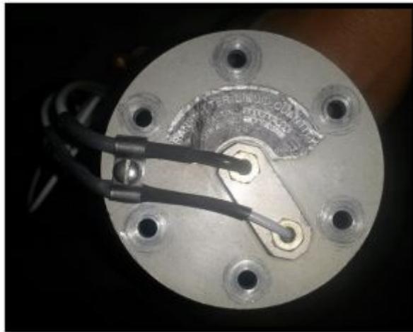
**Figura 19.** Capacitor de Combustible vista superior.
