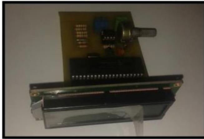
**Figura 21.** Circuito medidor de capacitancia.
