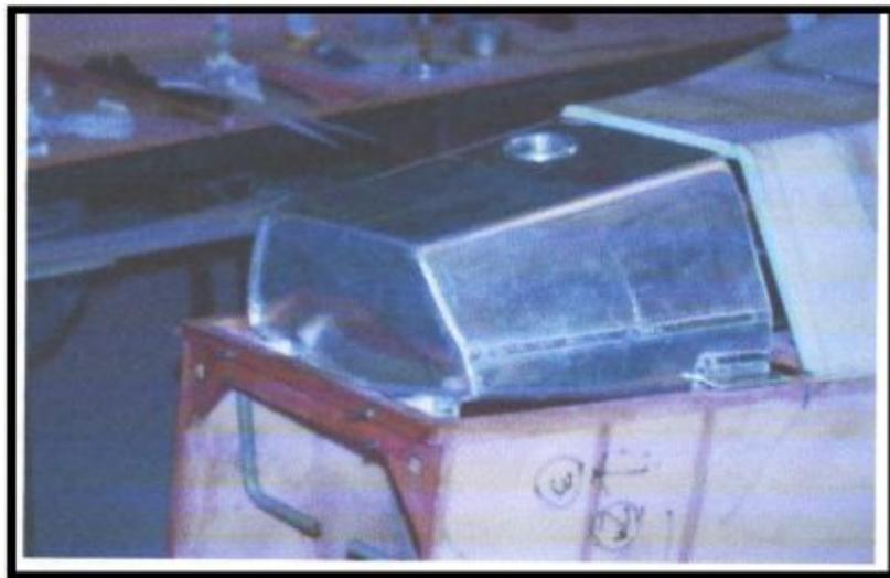
**Figura 15.** Tanque integral.
