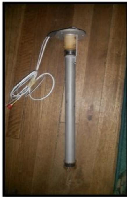
**Figura 18.** Capacitor de Combustible vista frontal.
