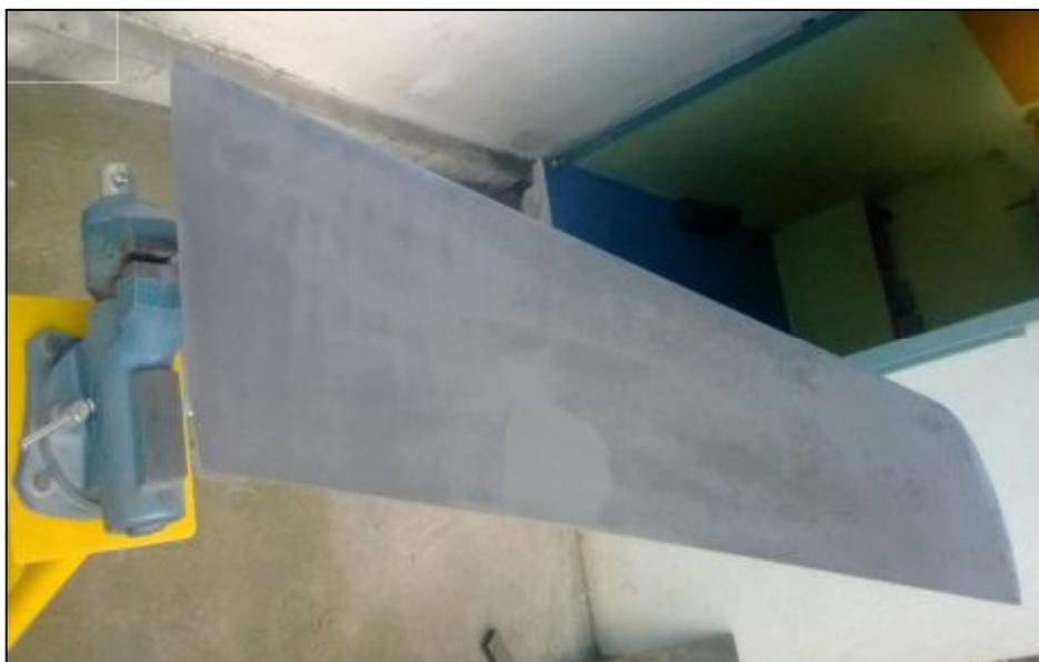
**Figura 17.** Flap con la capa de fondo plomo.
