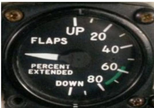
Figura 11. Indicador de posición de los flaps.
