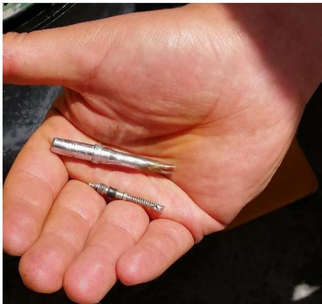
**Figura 6.** Válvula de inflado
