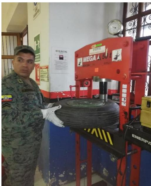
*Figura 52. Prueba de presión*
