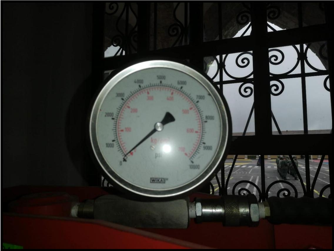
**Figura 50.** Manómetro de prensa hidráulica
