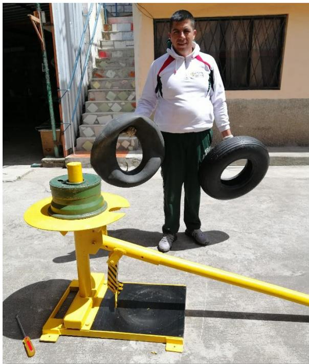
**Figura 9.** Desmontaje de Neumático
