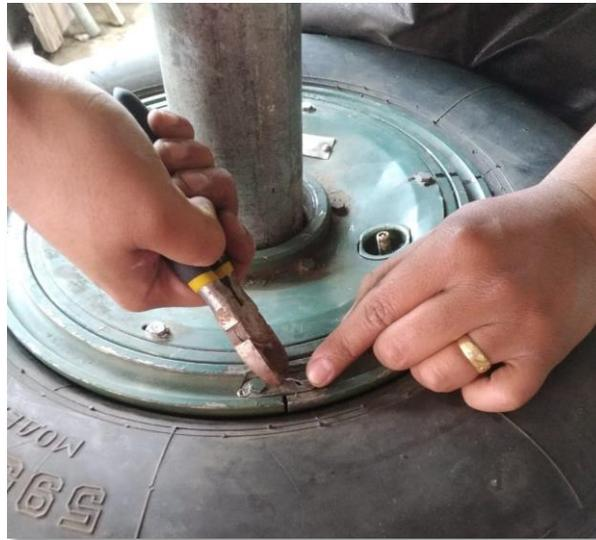
**Figura 10.** Frenado de seguridad
