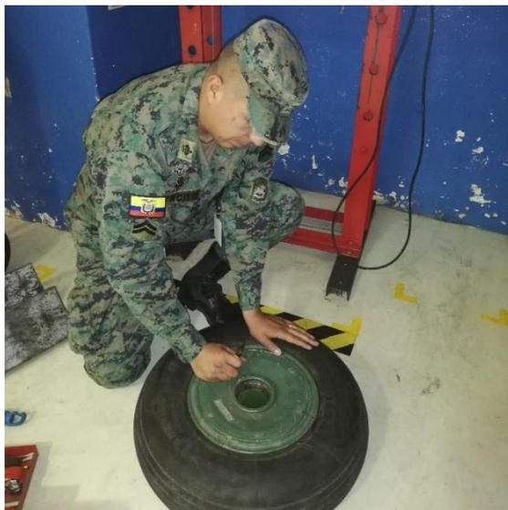
*Figura 51. Extracción del aire*
