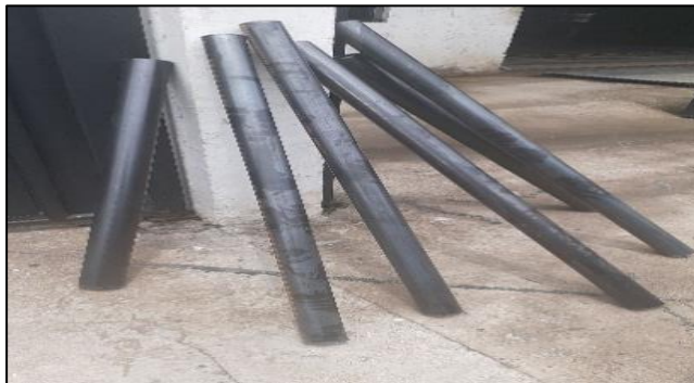
Figura 31. Tubería ced.40mm y tubería ISO.
