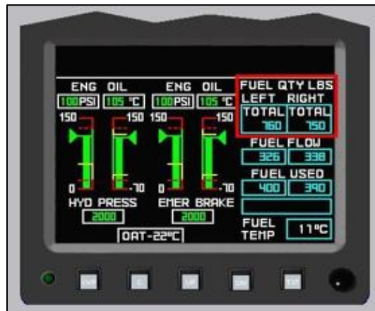
Figura 19. Indicador de combustible Fuente: (casa212-400)
