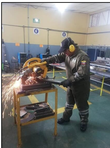
Figura. 28 Angulado de los tubos
