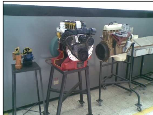
Figura N-4 Motores recíprocos seccionados.
