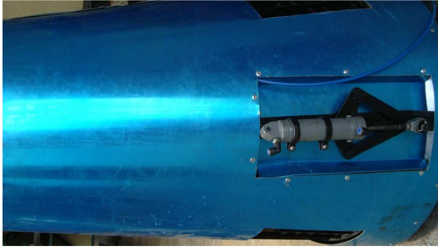
Fig. 3.24 Instalación de los Cilindros Neumáticos
