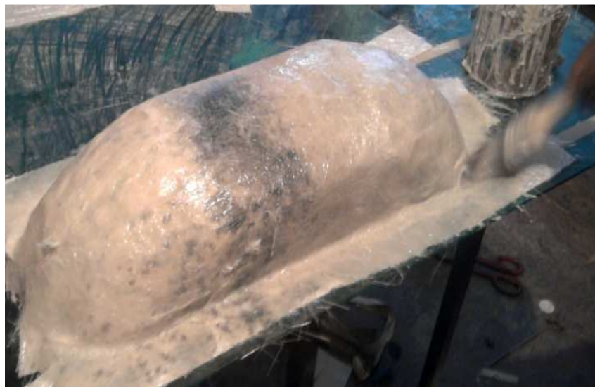
Fig. 3.20 Recubrimiento de la Mezcla en el Molde y la Fibra
