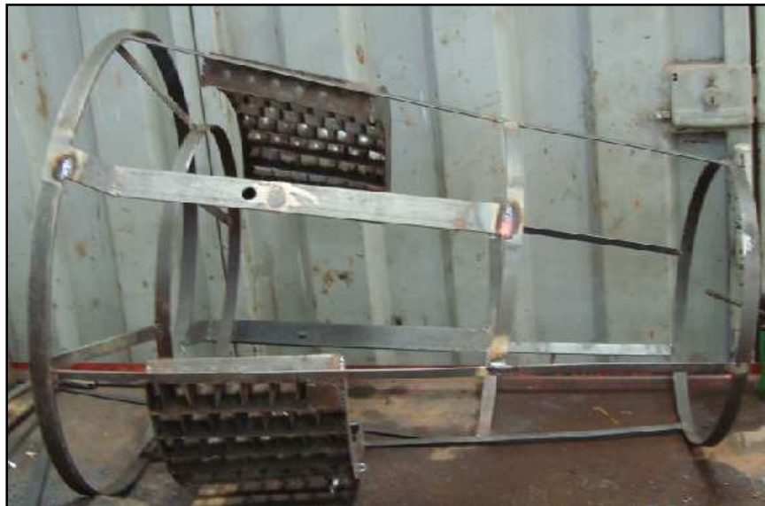
Fig. 3.10 Estructura de Alojamiento para el Cilindro
