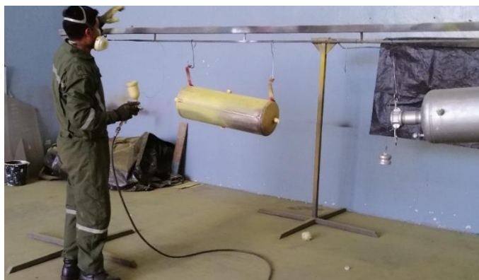
Figura 33. Aplicación del anticorrosivo
