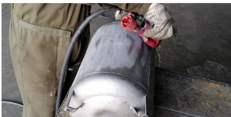
Figura 27. Lijado de tanques
