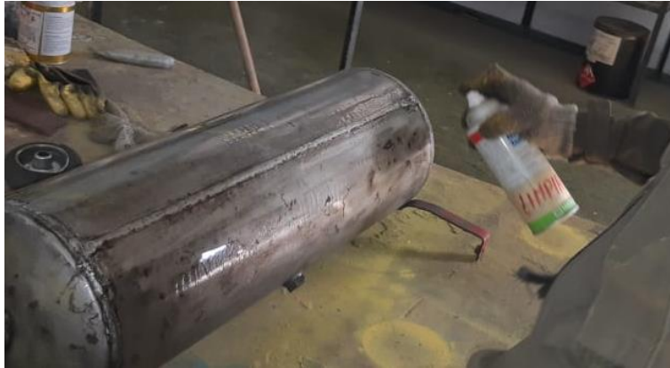
Figura 29. Aplicación de limpiador
