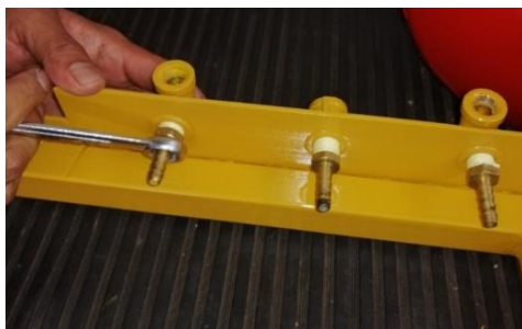
Figura 41. Colocación de acoples
