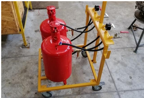
Figura 43. Colocación de manómetros.
