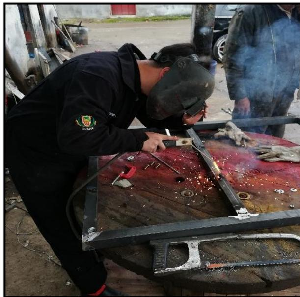
**Figura 23.** Soldadura del Marco de Tubo
