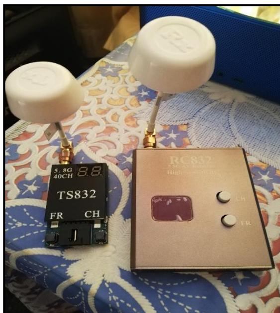
**Figura 37.** Transmisor y Receptor 832
