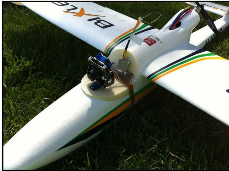
**Figura 9.** Aeromodelo con FPV
