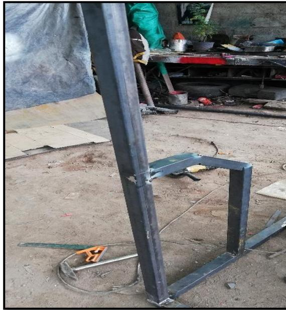
**Figura 25.** Pared lateral de la Cabina.
