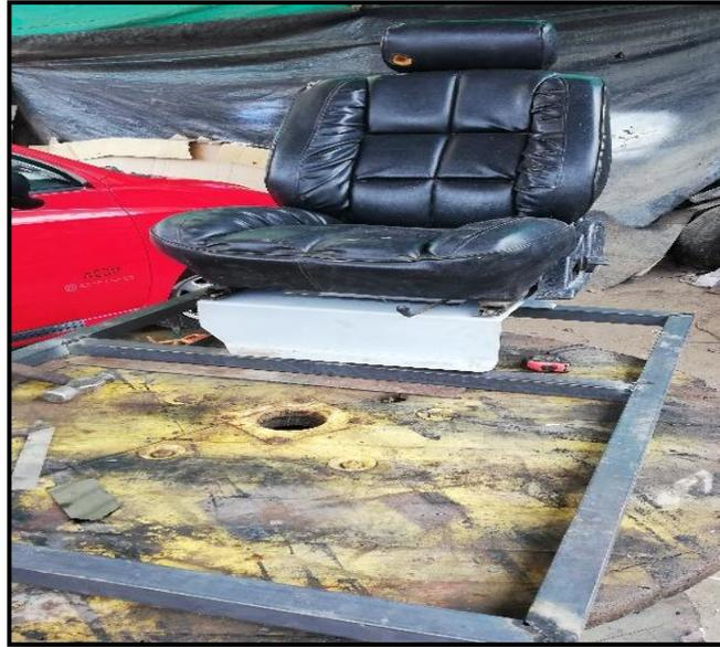
**Figura 21.** Base Estructural de la Cabina
