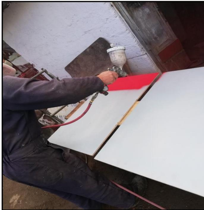
**Figura 35.** Aplicación de Pintura en los Paneles
