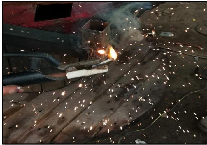
**Figura 24.** Soldadura del Tubo de Encaje
