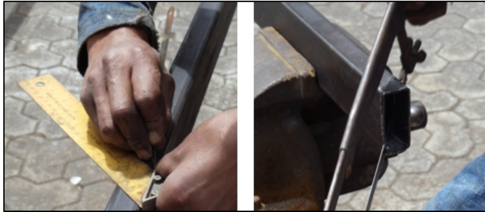
Fig. 3.13. Trazado y corte de la estructura base Fuente: Sr. Coello Tapia Luis Angel
