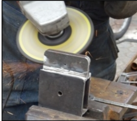
Fig. 3.26. Pulida de la eslinga regulable Fuente: Sr. Coello Tapia Luis Angel
