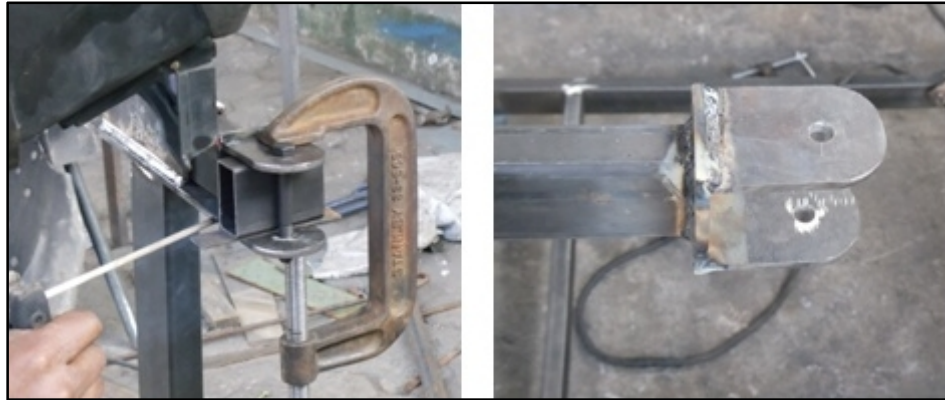
Fig. 3.27. Armado de los brazos del soporte Fuente: Sr. Coello Tapia Luis Angel
