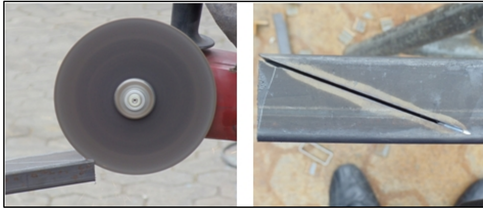
Fig. 3.17. Utilización del disco de corte Fuente: Sr. Coello Tapia Luis Angel
