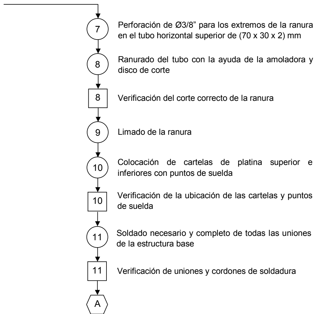
Fig. 3.33. Diagrama de procesos de la estructura base (2/2) Fuente: Sr. Coello Tapia Luis Angel
