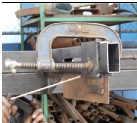
Fig. 3.25. Armado de la eslinga regulable Fuente: Sr. Coello Tapia Luis Angel
