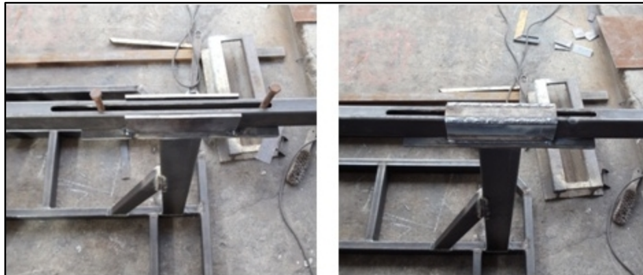
Fig. 3.24. Armado del adaptador deslizante Fuente: Sr. Coello Tapia Luis Angel
