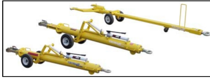
Fig. 2.15. Barras de remolque Fuente: TRONAIR Catalog TR082907
