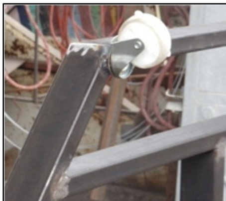
Fig. 3.30. Colocación de garruchas Fuente: Sr. Coello Tapia Luis Angel
