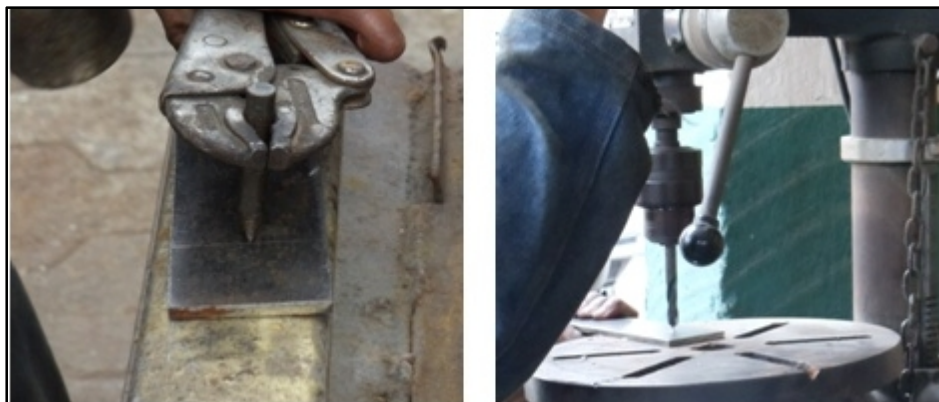
Fig. 3.22. Perforaciones en el adaptador deslizante Fuente: Sr. Coello Tapia Luis Angel
