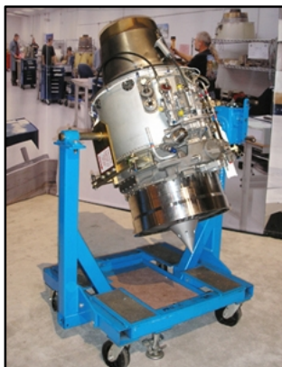
Fig. 2.24. Soporte de trabajo para motores turbina Fuente: TRONAIR Catalog TR082907
