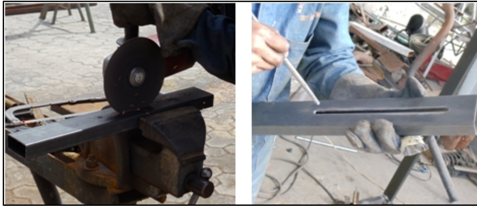
Fig. 3.19. Ranurado y limado del tubo horizontal superior Fuente: Sr. Coello Tapia Luis Angel
