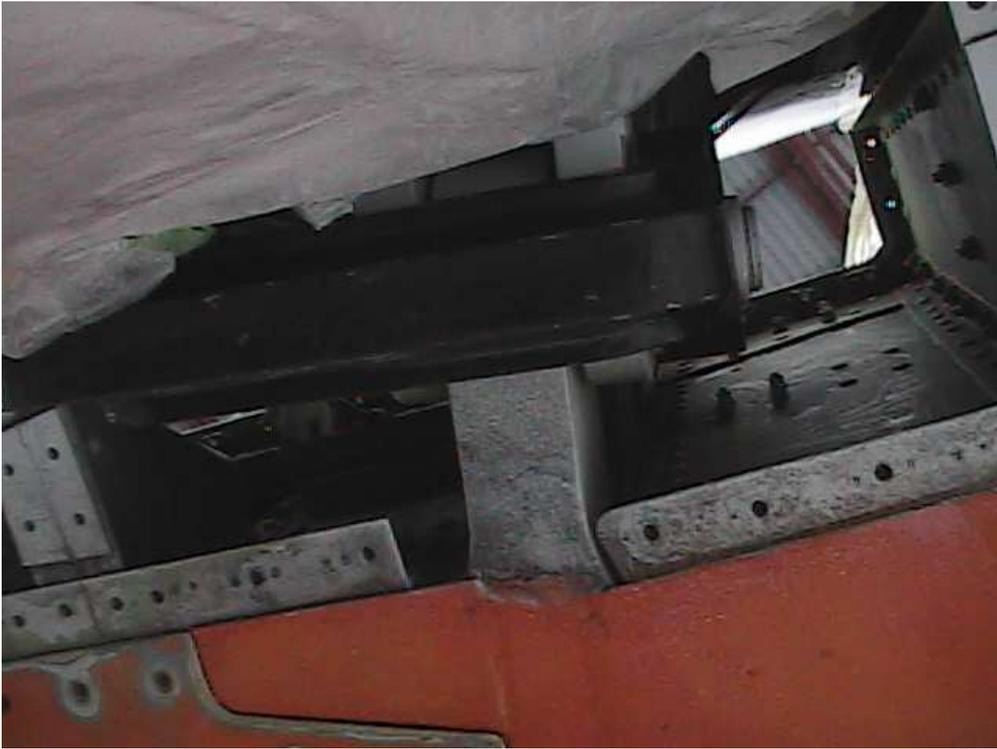
Fig. 3.17 Extracción del pin en el Estabilizador Horizontal
