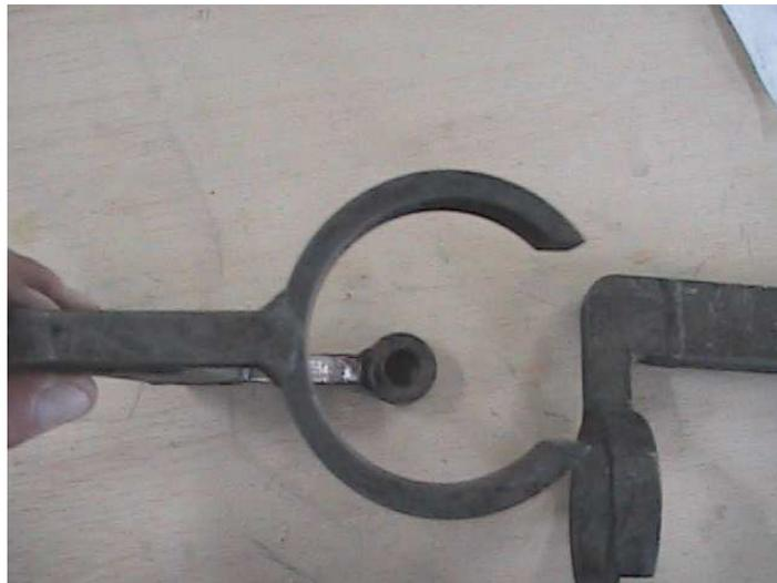
Fig. 3.14 Soldado y cortado el anillo para que sea horquilla
